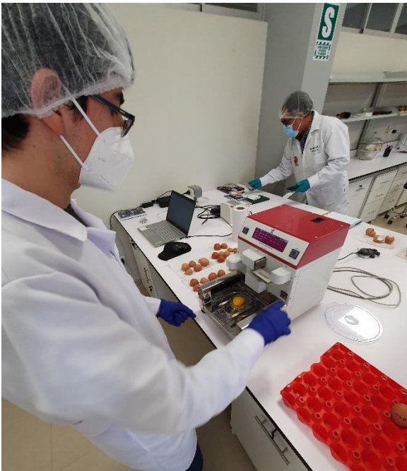
Foto N° 4 realizando calidad de huevo en el equipo digital Egg Tester Det 6500.
