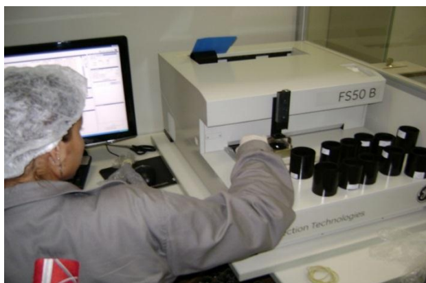
Figura N° 02: Digitalización de películas radiográficas – Fuente: http://www.arctest.com.br/es/digitalizacion-de-peliculas-radiograficas
