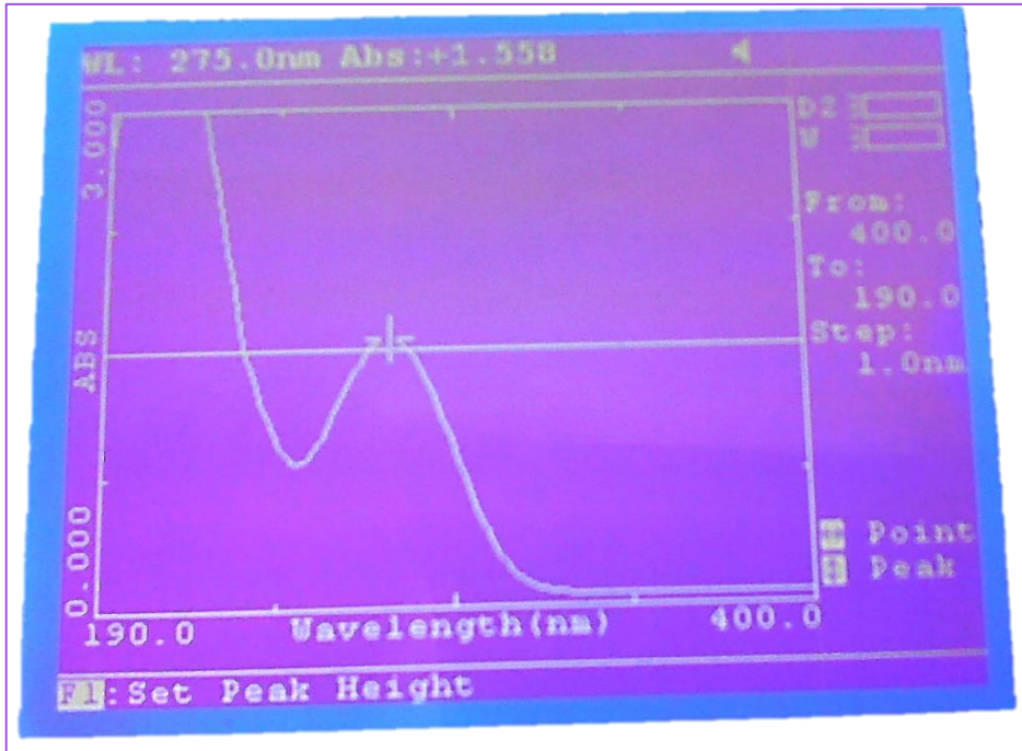
g. Lectura de la tab. de referencia, UV a 275nm
