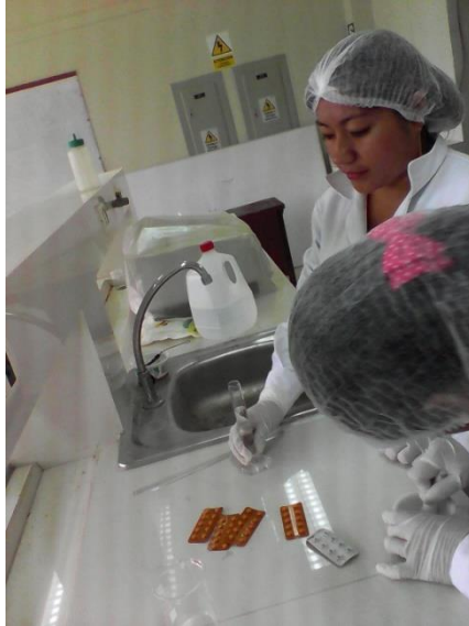
a. Trituración de 20 tabletas de cada muestra
