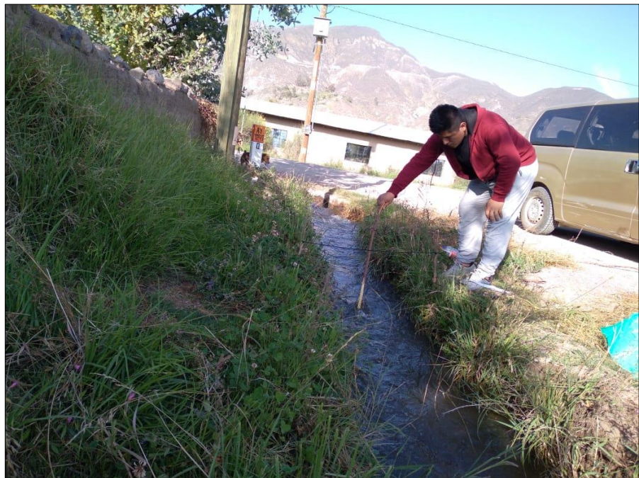
Fig. 16. Obtención de profundidades del canal
