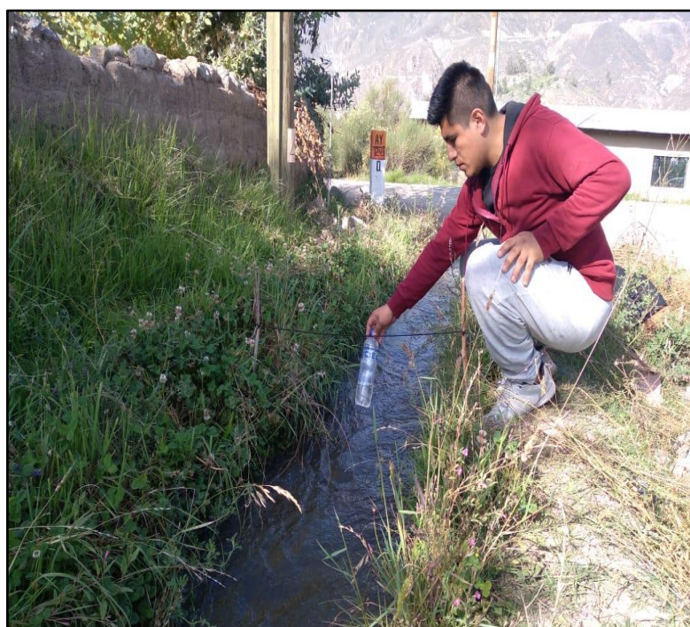
Fig. 60. Medición de velocidad por el método del flotador
