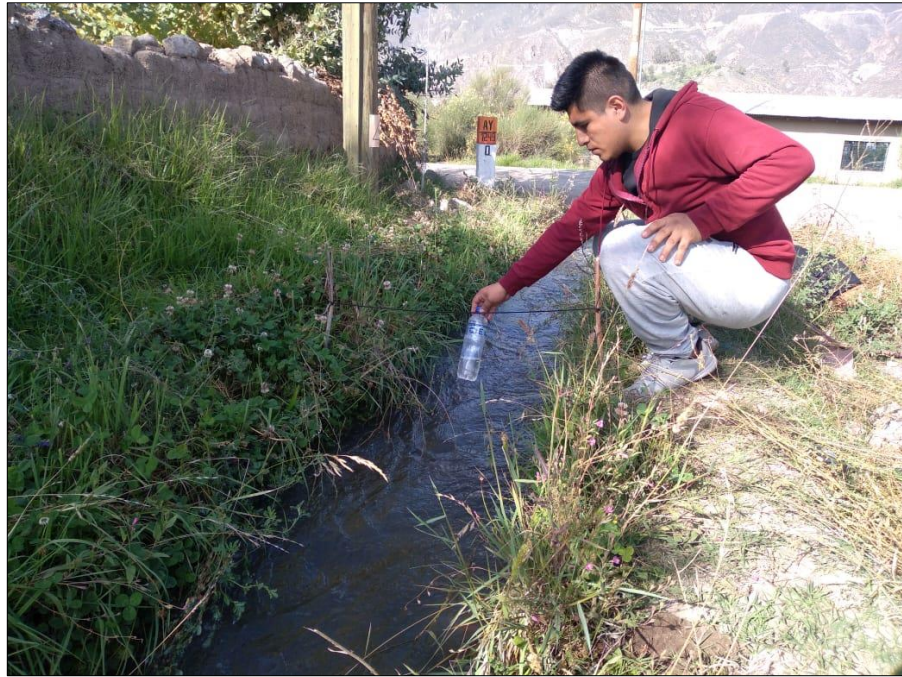
Fig. 17. Soltando en flotador en el inicio del tramo de aforo
