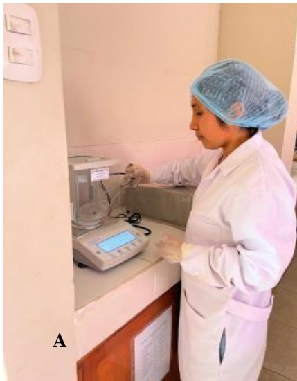
Figura N°34. Determinación de sólidos totales: A) Pesado de la muestra en la placa Petri. B) Placa Petri con sólidos del extracto en un desecador.
