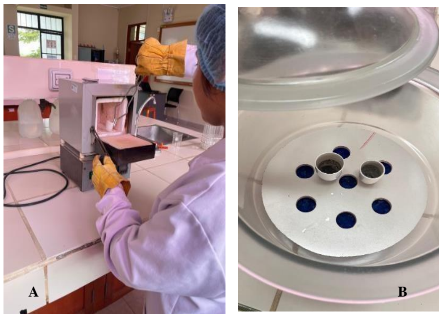
Figura N°36. Determinación de cenizas: A) Calcinar la muestra en la mufla a 550°C. B) Llevar los crisoles en el desecador.
