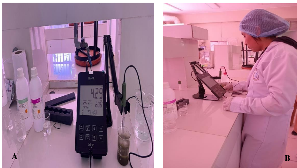
Figura N°37. Determinación de pH: A) Calibración del pHmetro. B) Medición del pH de la muestra.
