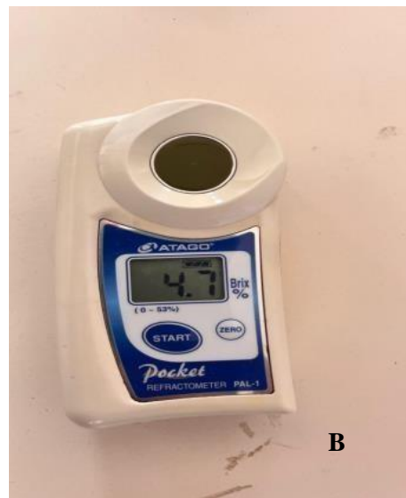
Figura N°35. Determinación de sólidos solubles: A) Calibración B) Medición de sólidos solubles.
