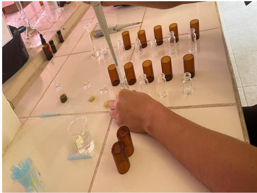
Figura N°40. Cuantificación de Polifenoles Totales: método de Folin-Ciocalteu.
