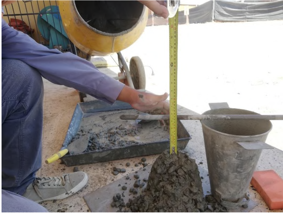
Ensayo de consistencia del concreto con aditivo con dosificación media y 20% de reducción de agua
