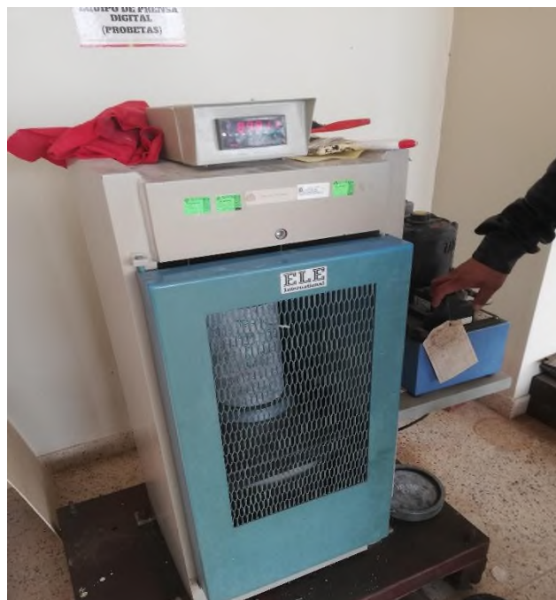
Ensayo de resistencia a la compresión a las probetas del nuevo diseño de mezcla sin aditivo y con aditivo
