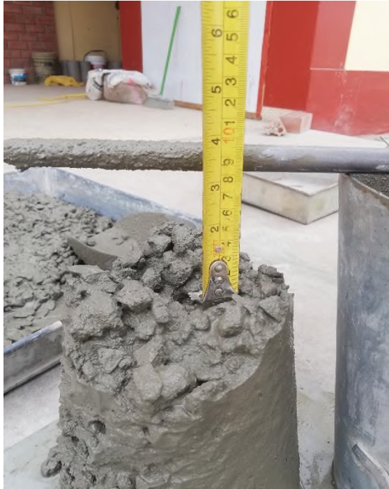
Ensayo de consistencia al concreto patrón a los 7 días
