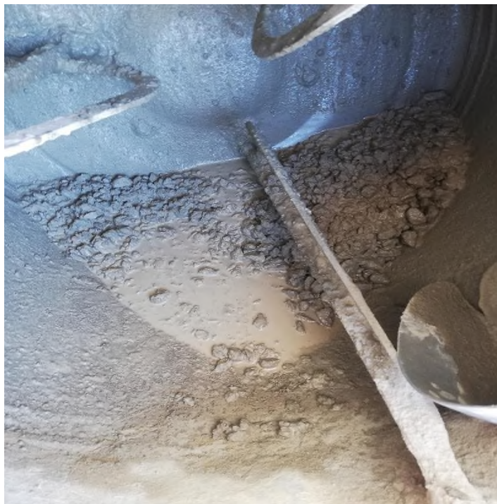
Muestra de segregación con el aditivo superplastificante sika visocrete 1110 PE en su dosificación media reduciendo 10% de agua
