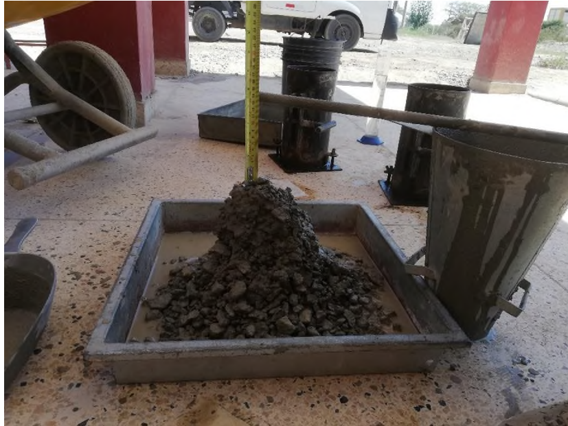
Muestra de segregación del concreto con el aditivo superplastificante sika visocrete 1110 PE con su dosif. media y 10% reducción de agua
