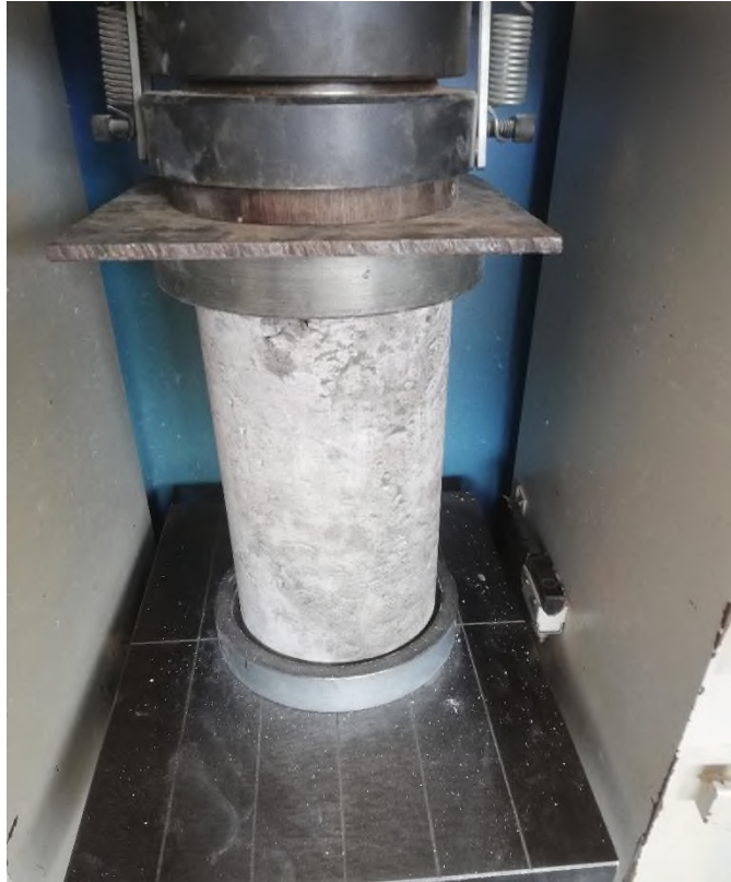
Probeta sometida al ensayo de resistencia a la compresión
