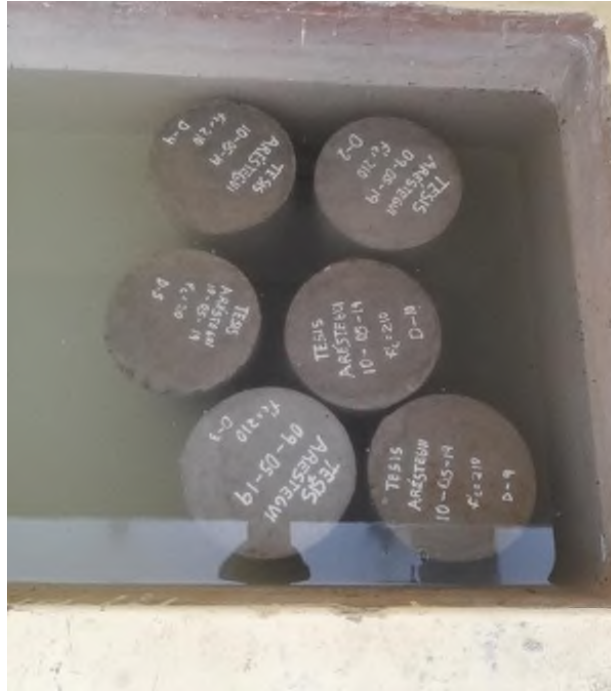
Curado de las probetas de concreto en el pozo de curado
