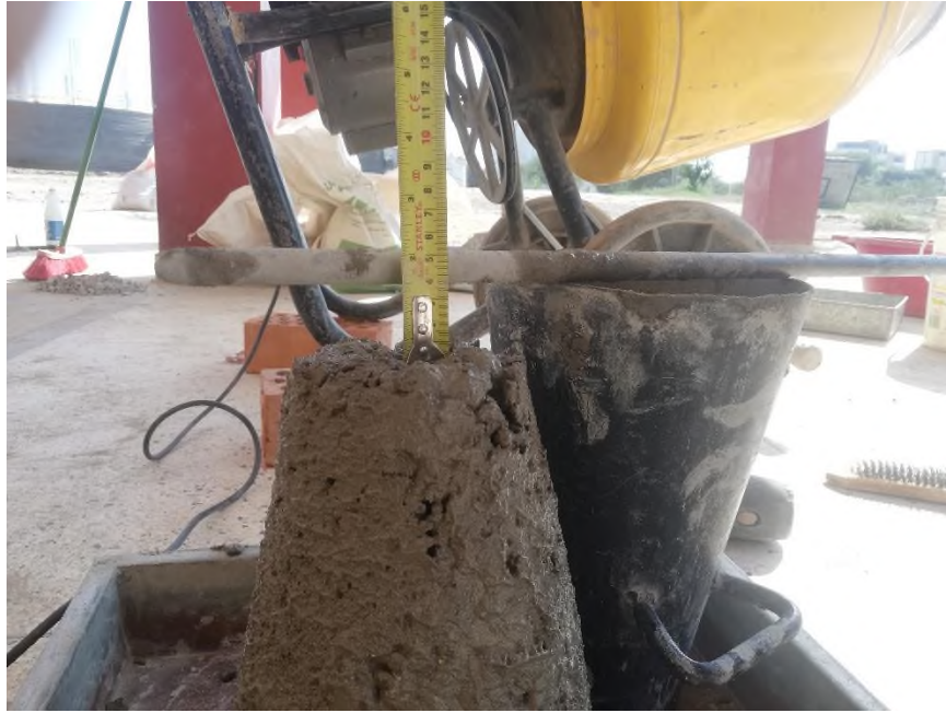
Ensayo de consistencia para el concreto con aditivo superplastificante en la dosis mínima reduciendo el 30% del agua efectiva
