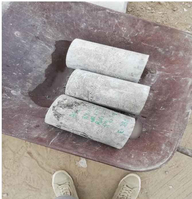
Probetas del nuevo diseño de mezclas después de ser ensayadas
