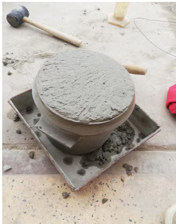
Ensayo de peso unitario del concreto patrón
