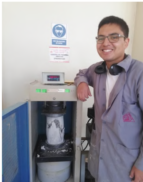
Ensayo de resistencia a la compresión
