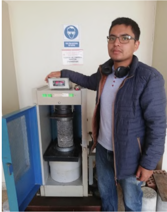
Ensayo de resistencia a la compresión
