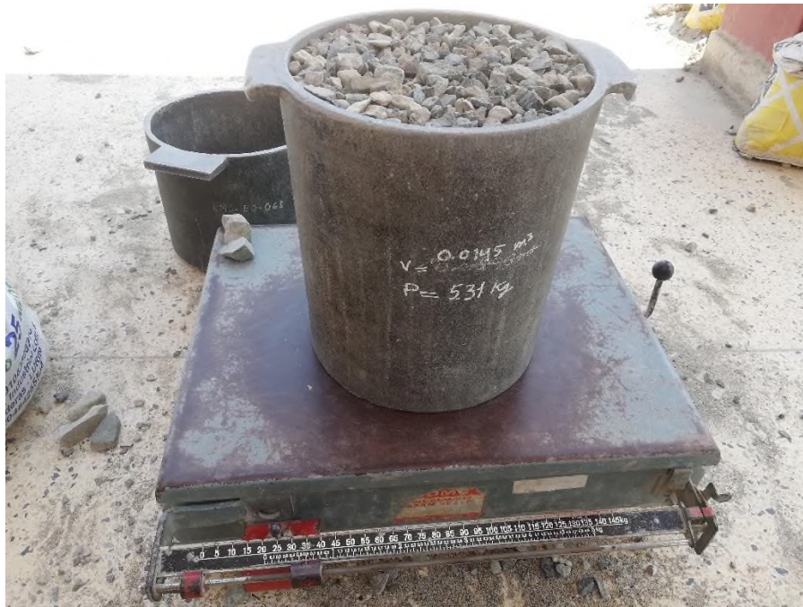
Ensayo de peso unitario del agregado grueso
