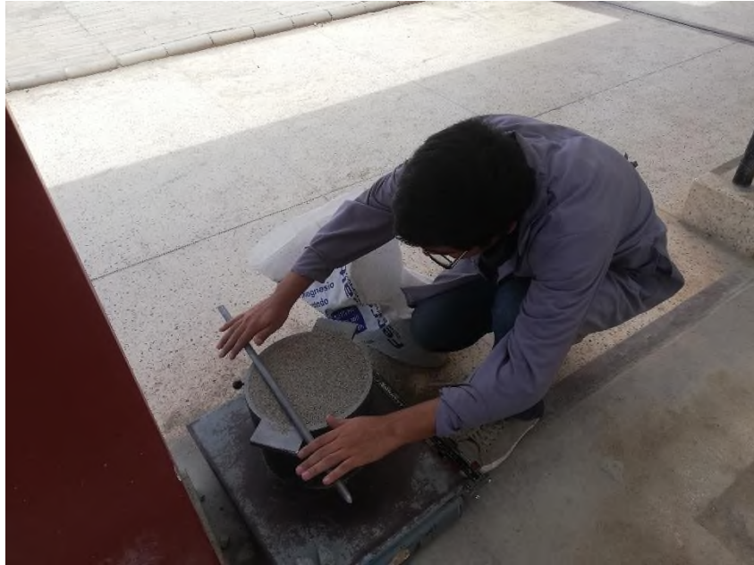
Ensayo de peso unitario del agregado fino
