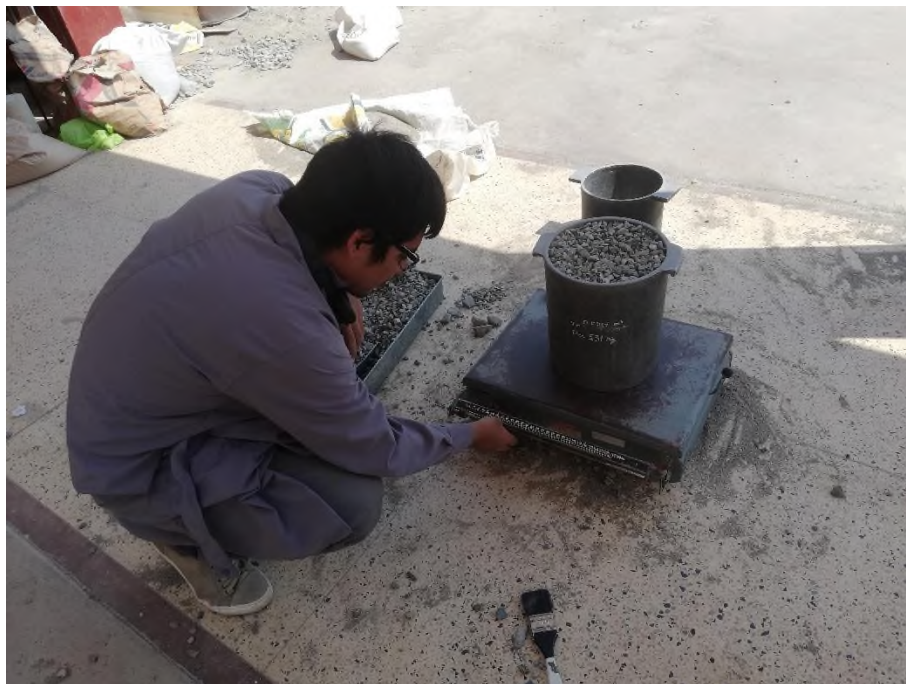
Calculando el peso unitario del agregado grueso
