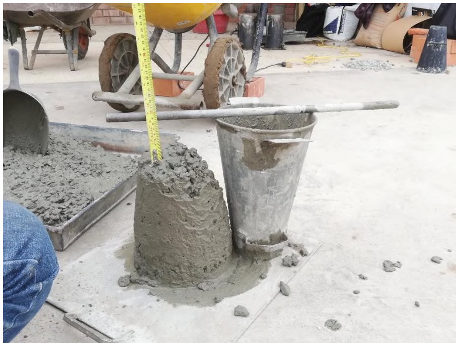
Ensayo de consistencia del concreto patrón
