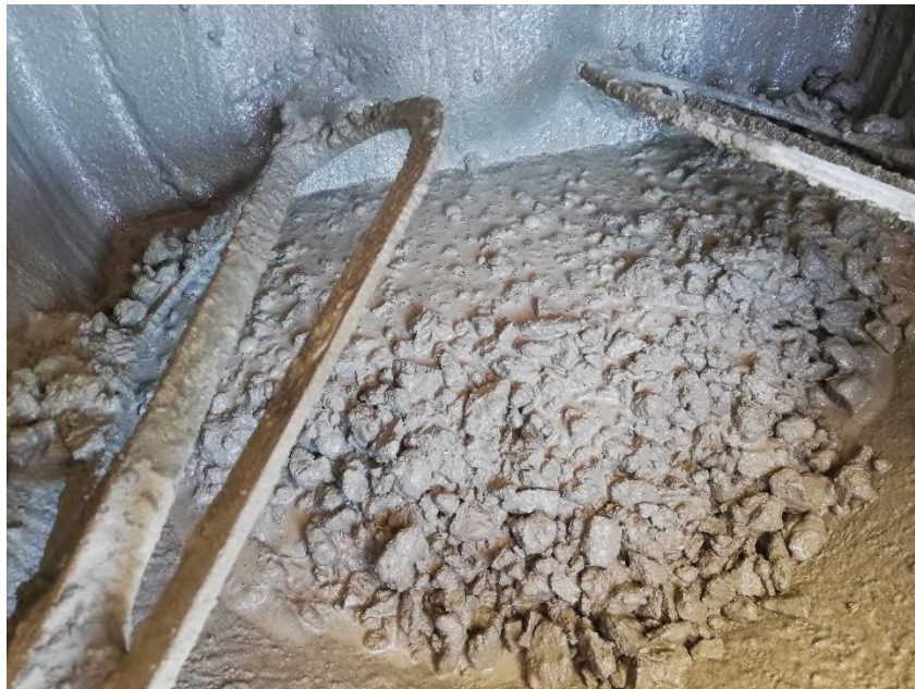
Diseño de mezcla con el aditivo superplastificante sika visocrete 1110 PE en su dosificación media reduciendo 10% de agua.
