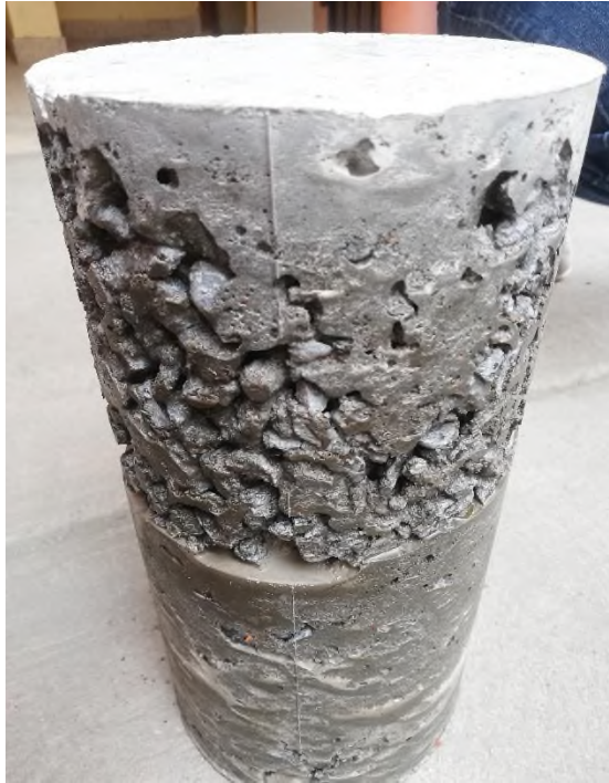
Muestra de la segregación de una probeta mal elaborada con la dosificación no apropiada
