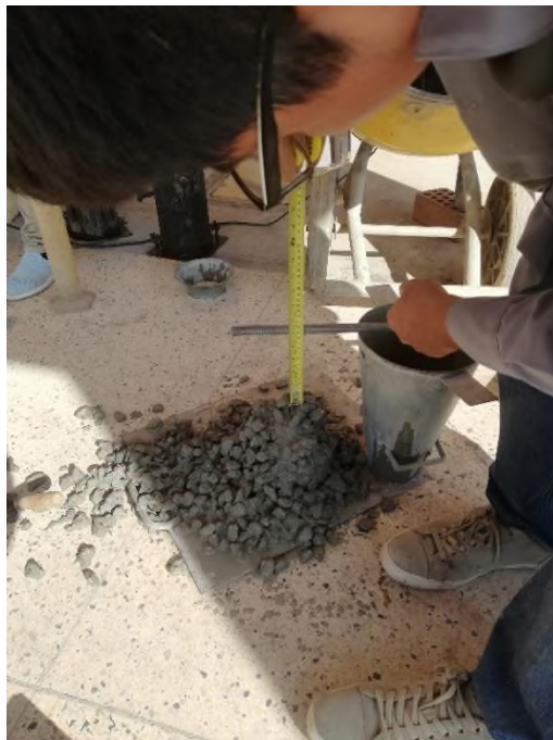
Muestra de segregación con el aditivo superplastificante sika visocrete 1110 PE en su dosificación media sin reducir agua
