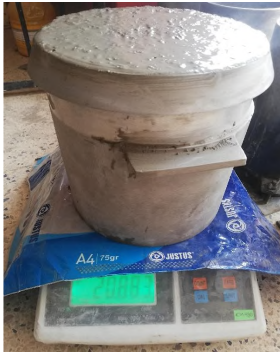
Ensayo de peso unitario del concreto con aditivo superplastificante
