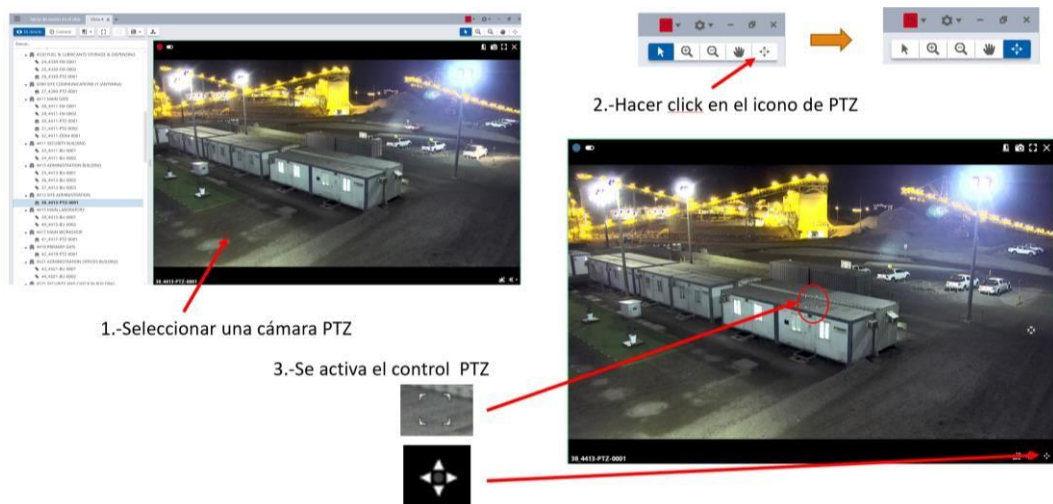
Figura 56: ACC7 – Control de cámara PTZ (Parte 01)
