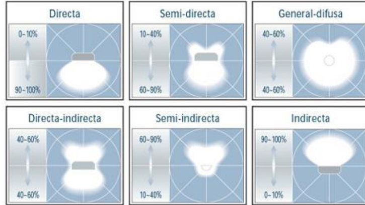
Fig N° 8: Distribución fotométrica Fuente: Iluminación [21]
