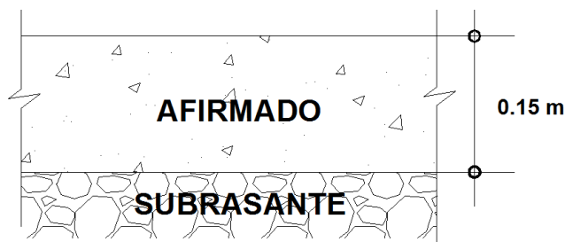
Figura 8 Estructura de la superficie de rodadura
