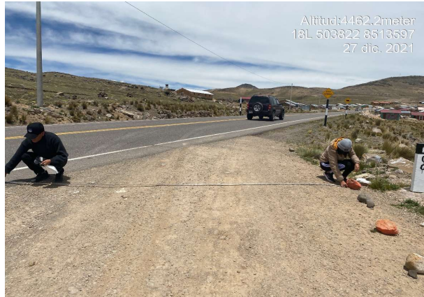
Figura 109: Medición del ancho de calzada en el KM 0+000.
