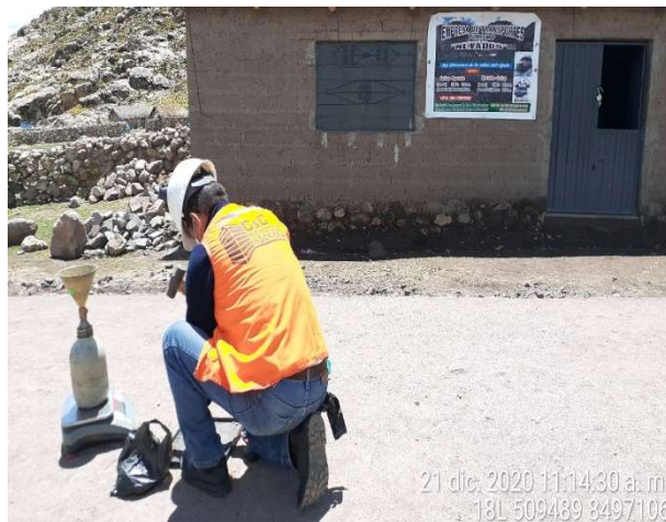
Figura 101: Ensayo de densidad de campo KM 27+000
