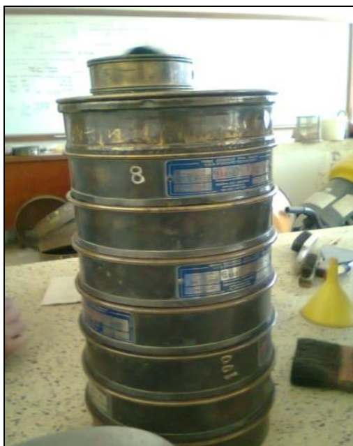
FIGURA No.52 SE APRECIA LOS TAMICES MONTADOS DENTRO DE UNA ARMADURA
