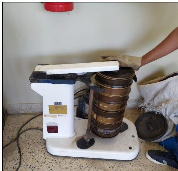
FIGURA No.35 LA TAMIZADORA ELÉCTRICA REALIZA MOVIMIENTOS RADIALES CONTINUOS
