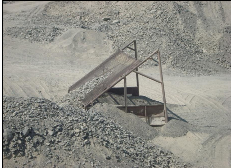
FIGURA No.50 SE OBSERVA CÓMO SE SELECCIONA EL AGREGADO GRUESO
