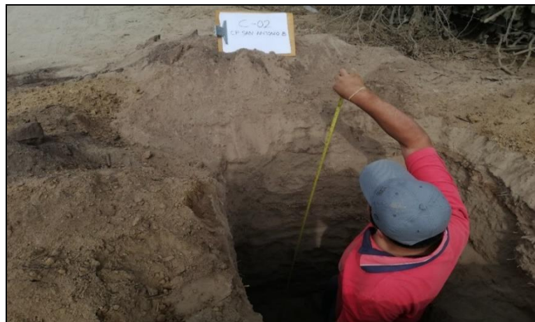
Foto 11 MEDICIÓN DE PROFUNDIDAD DEL POZO No.02
