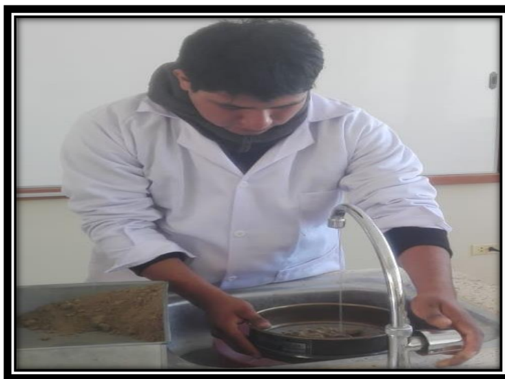
Ilustración 11 lavado de la muestra para la granulometría
