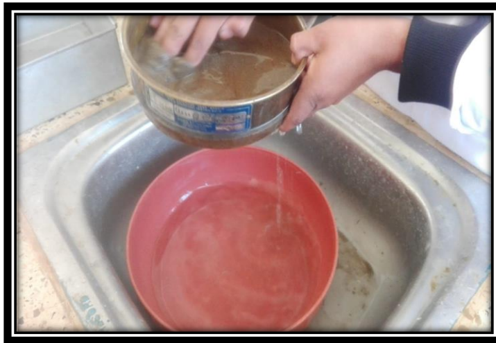
Ilustración 12 la muestra después del lavado debe de quedar así
