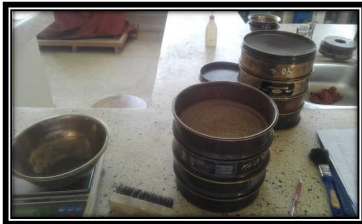
Ilustración 15 pesado de cada tamices para el resultado
