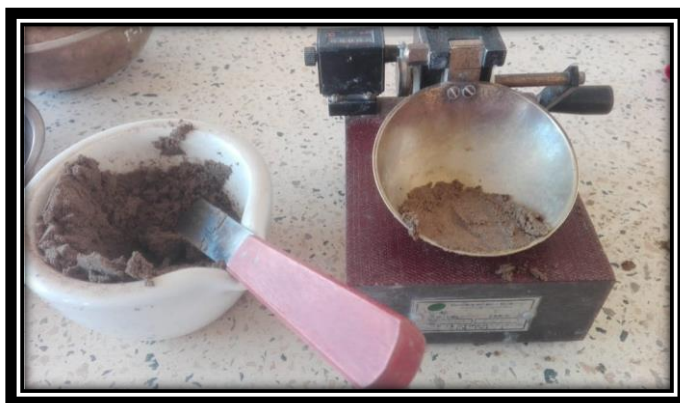
Ilustración 21 llenado de la Casagrande
