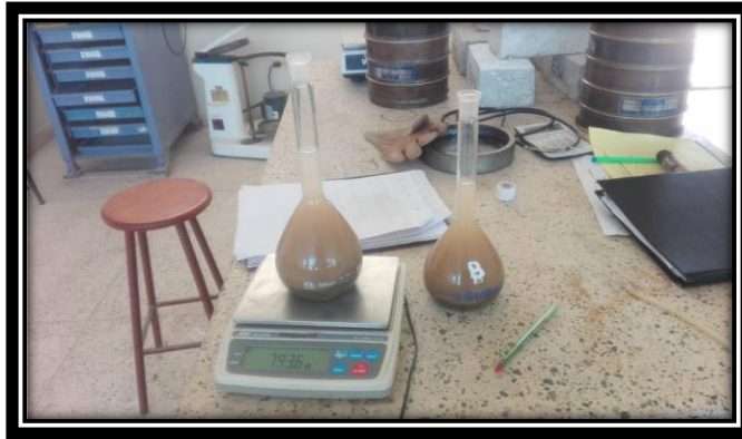
Ilustración 19 pesado de la muestra
