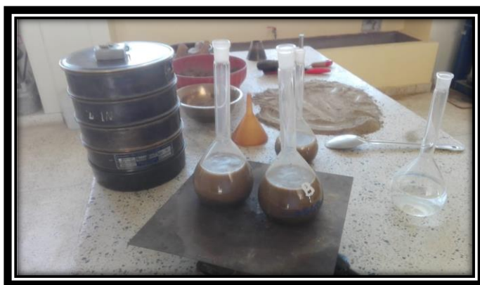
Ilustración 18 calentando el picnómetro.
