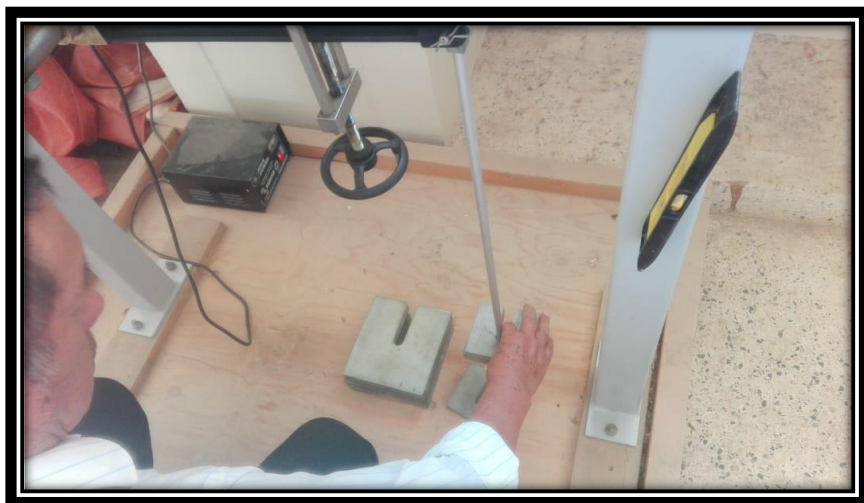
Ilustración 32 calibrando el peso del corte directo
