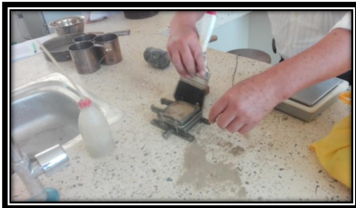
Ilustración 28 poniendo la muestra para llevar al equipo del corte directo
