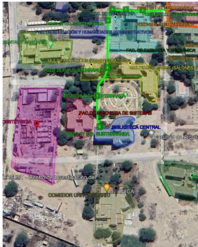
Fig. 27. Diseño del área 03 de la red GPON en la Ciudad Universitaria. [Google Earth] [Edición Propia].
