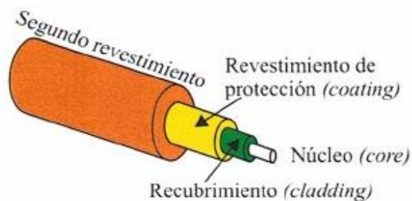
Fig. 10. Características de un filamento de fibra óptica. [12]
