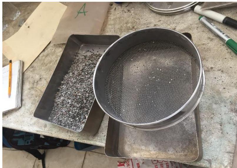
Figura N°10.- Zarandeo de mineral triturado -10M
