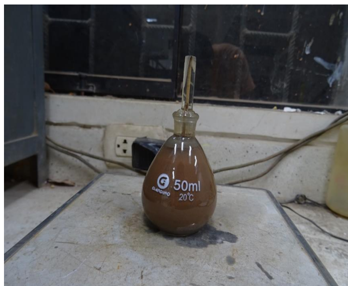
Figura N°12.- Prueba por el método del picnómetro
