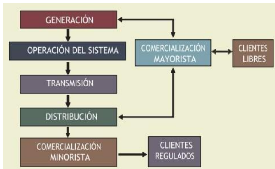
Fig. 2 Sistema eléctrico en el Perú
