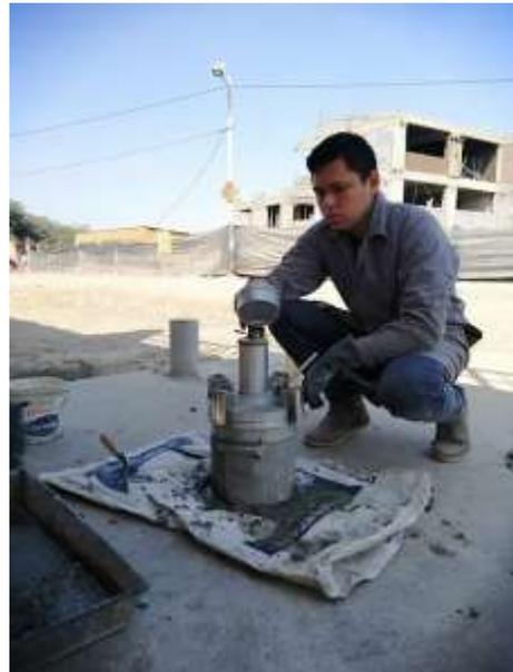
Figura 58. Ensayo de exudación
