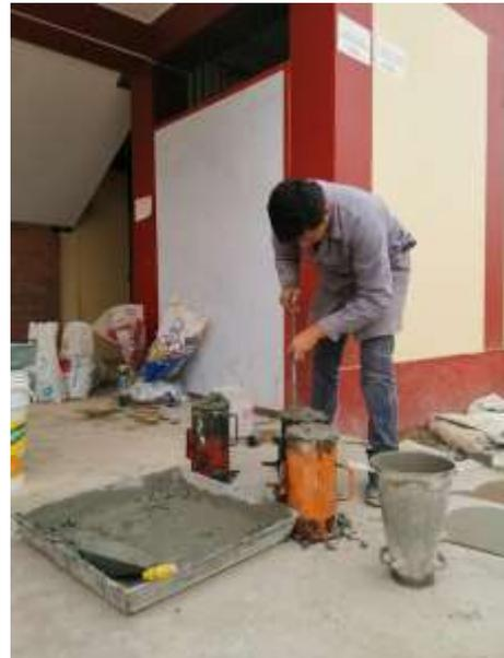
Figura 56. Ensayo de consistencia del concreto / 0.3% aditivo
