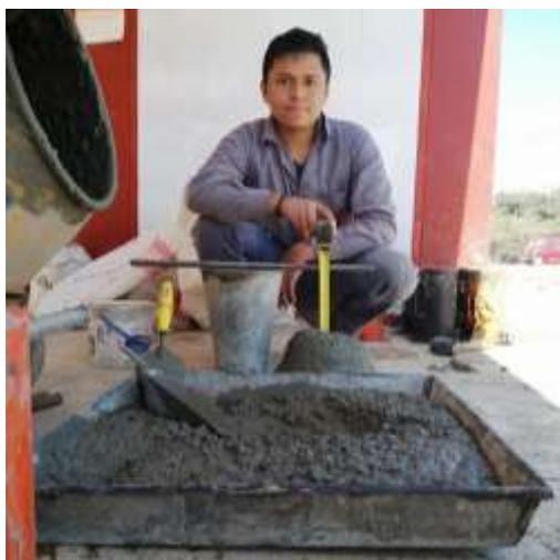
**ENSAYOS DE CONSISTENCIA PARA CONCRETO PATRÓN**
