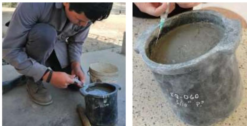
Se realizaron tres ensayos de exudación para cada diseño de mezcla elaborado, de los cuales se obtuvieron sus valores promedios los cuales se presentan en las tablas 43, 44 y 45. Los ensayos se realizaron a la misma hora y con condiciones ambientales similares para que la dispersión por factores de temperatura y ambientales sea mínima y de esta forma no afecte el ensayo de exudación del concreto.
