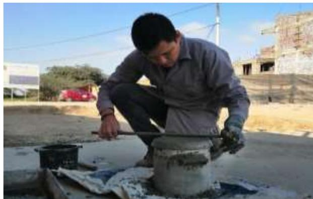
Se realizaron dos ensayos de peso unitario a cada diseño de mezcla elaborado en el proyecto de investigación, de los cuales sus valores se ven expresados en las tablas 39, 40 y 41, mostradas a continuación:
