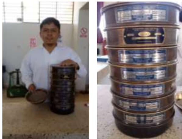
Figura 10. Procedimiento de tamizado de muestra de agregado fino.
