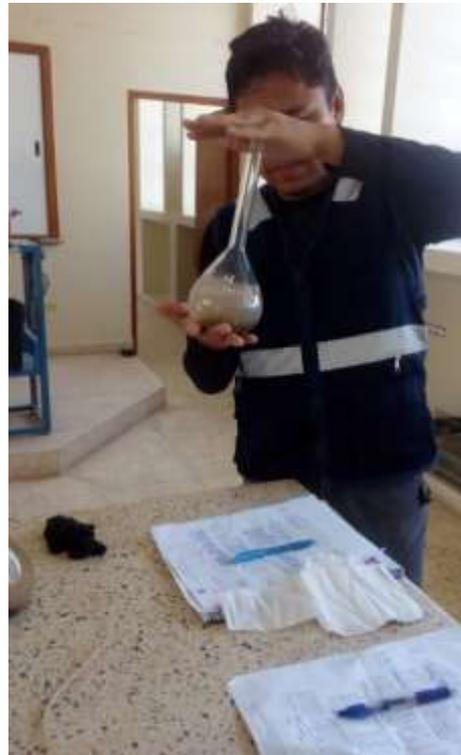
Se realizaron 3 ensayos consecutivos del ensayo de peso específico para el agregado fino de los cuales los resultados obtenidos fueron los mostrados en la Tabla 17, que se muestra a continuación:
