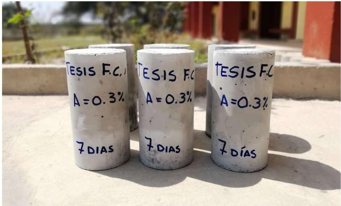
Figura 60. Rotura probetas con aditivo 0.3%
