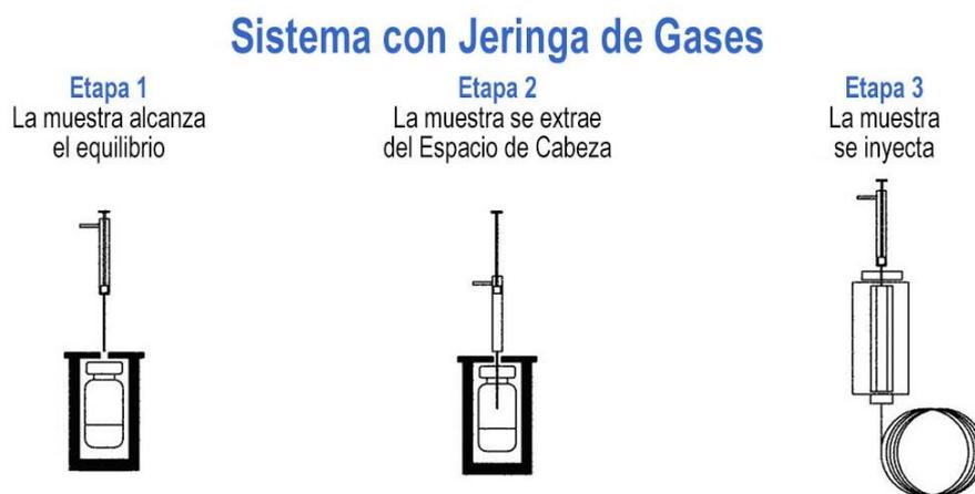
**Figura 7.** Inyección con jeringa para gases en el cromatógrafo.
