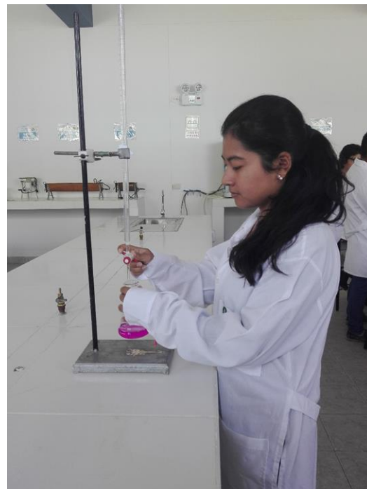
Foto 1. Determinación de la dureza del agua.
