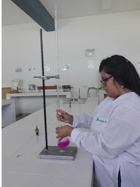
Foto 1. Determinación de la dureza del agua.
