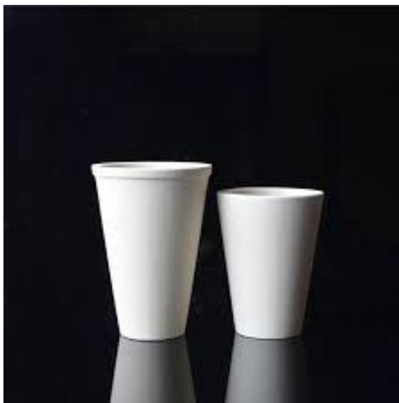
Figura 2. Crisol de arcilla para análisis de oro.
