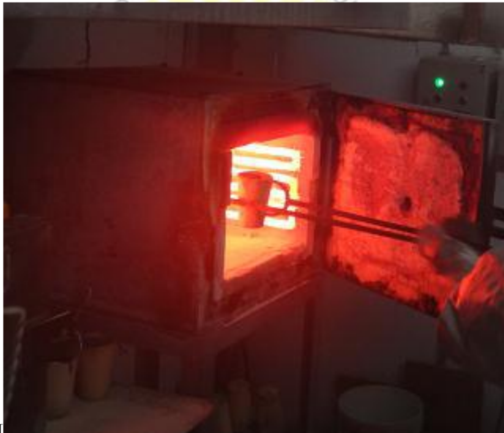
Figura1. Mufla al rojo vivo durante la fusión del mineral aurífero.
