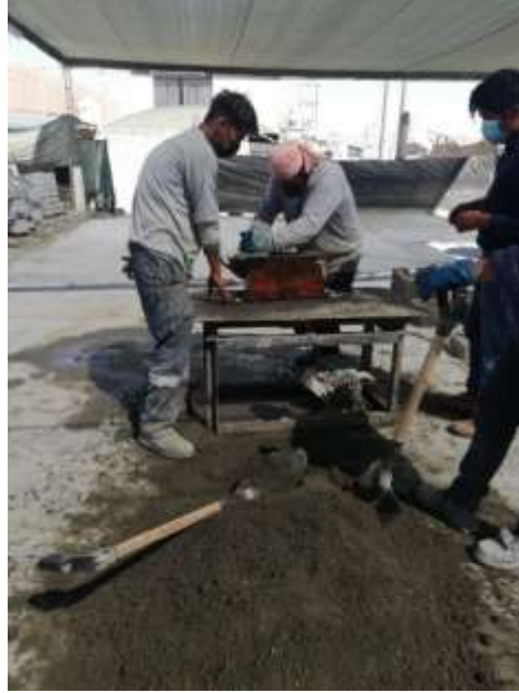
Figura 4: Máquina vibradora para elaboración de bloques
