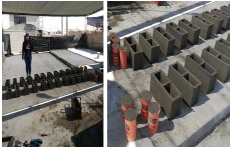
Figura 5: Bloquetas y probetas de concreto reciclado
