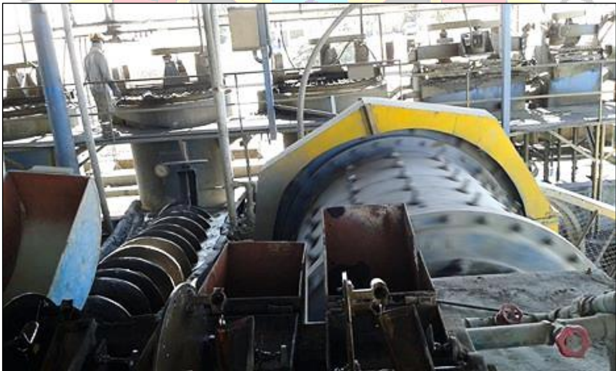
Figura 16: Molino de bolas y clasificador helicoidal en by pass
