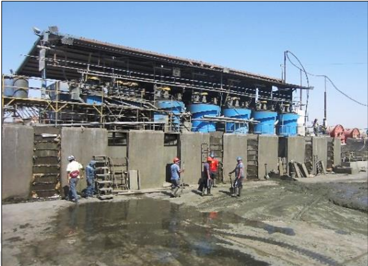
Figura 19: Circuito de flotación, pozas de sedimentación de concentrado final y cancha de concentrado
