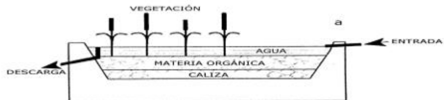
Figura 20. Humedal anaeróbico de flujo vertical.
