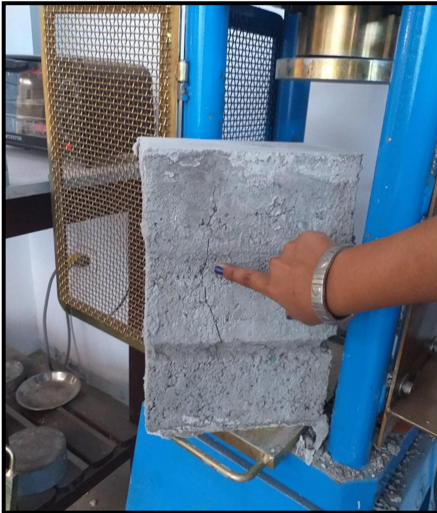
Anexo N°22 Ensayo de Pilas falla atraviesa la unidad de albañilería y la junta de mortero.
