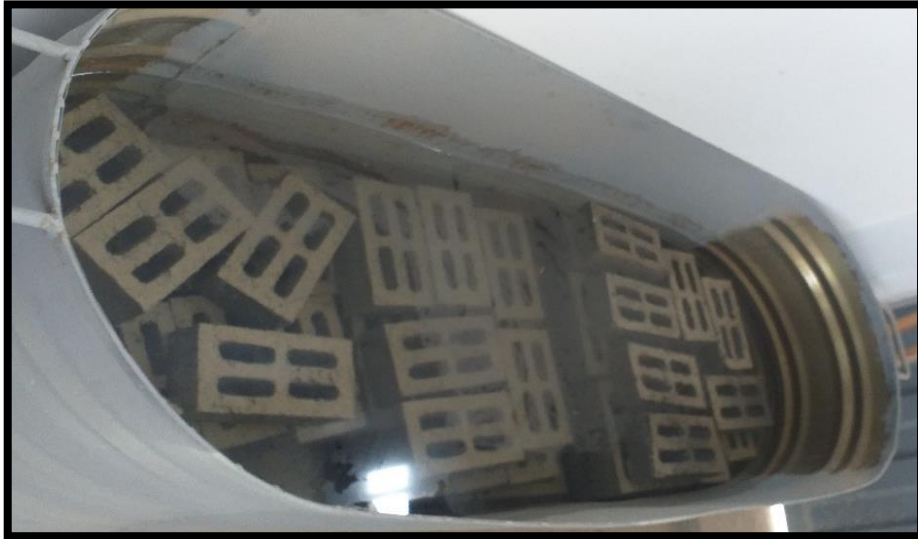
Fig. 10 Poza de curado de Unidades de Albañilería.
