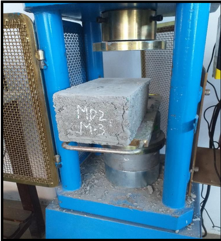
Anexo N°23 Refrentado de Pilas de Ladrillos de concreto PET.
