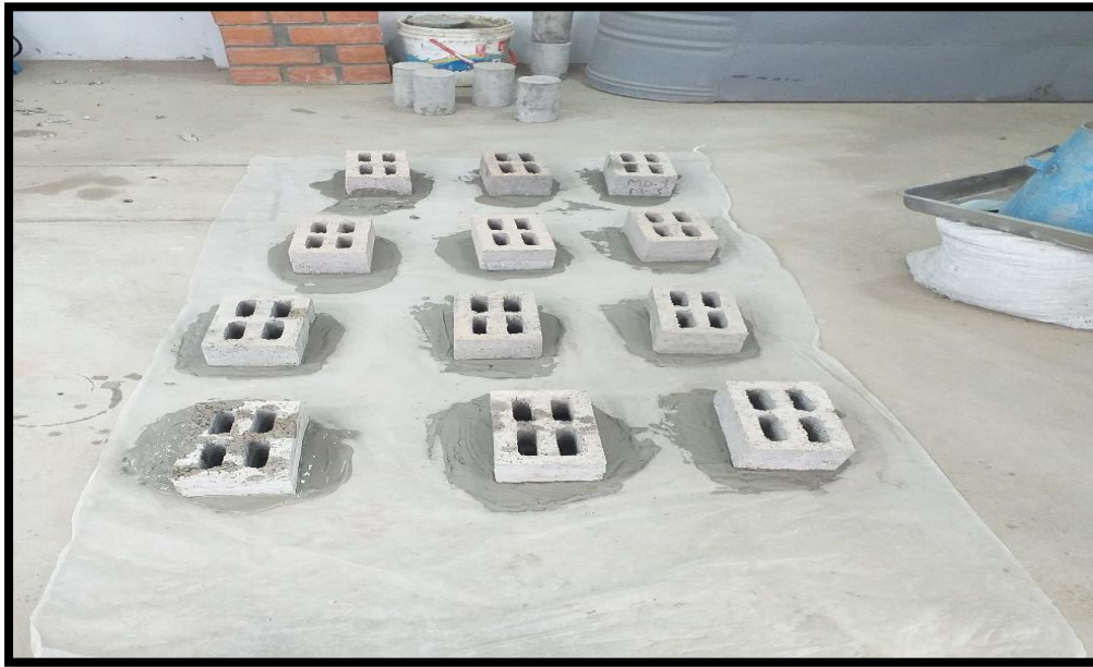
Anexo N°17 Refrentado o llamado “Capping” a los ladrillos de Concreto PET.
