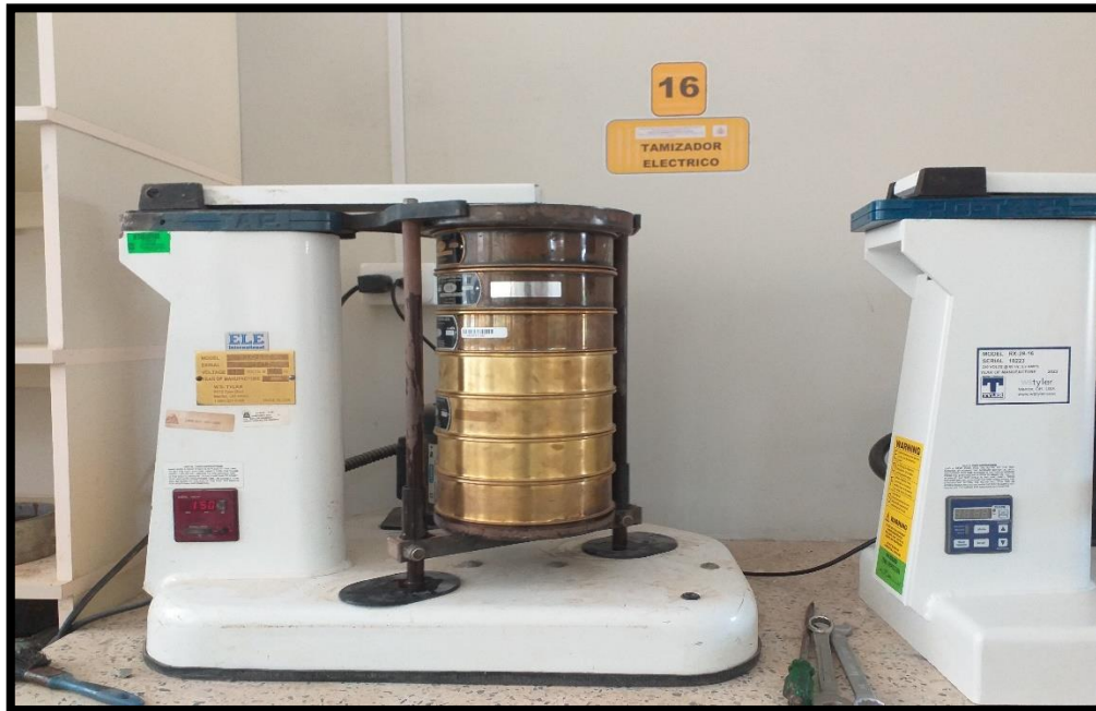
Anexo N°1 Análisis Granulométrico de Agregado Fino.
