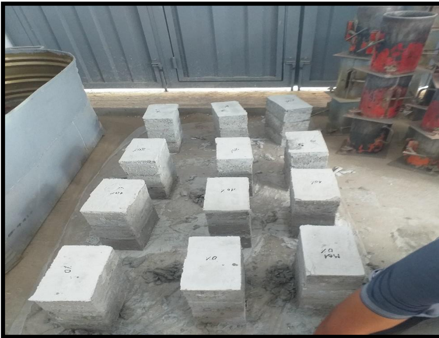
Anexo N°24 Ensayo de Resistencia a compresión de Ladrillos de concreto PET.
