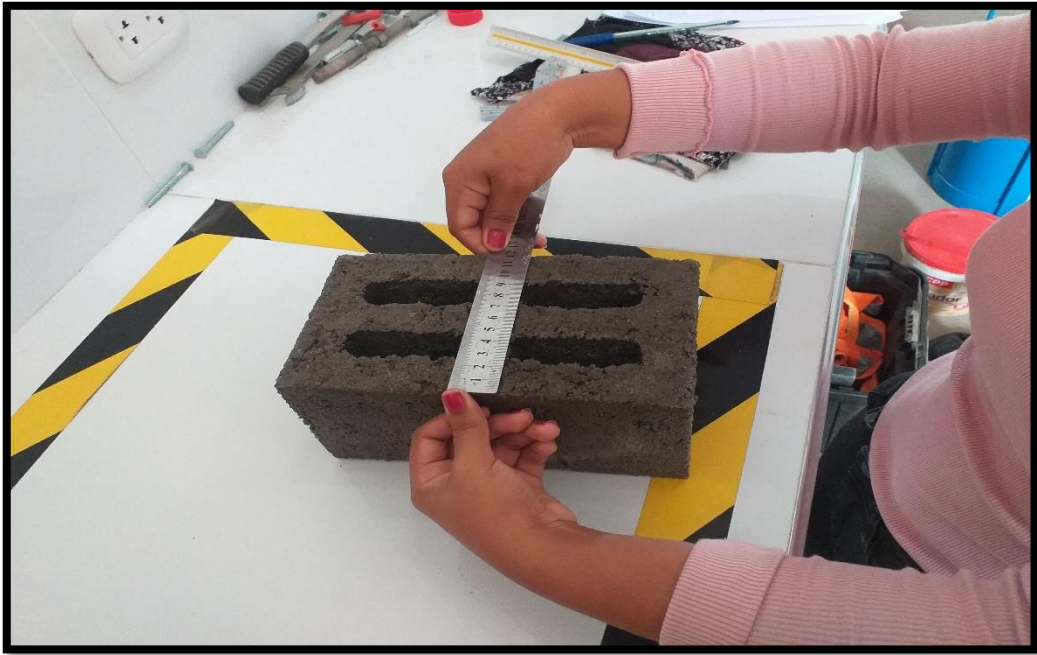
Anexo N°13 Ensayo de Variación de Dimensiones Ladrillos de Concreto.
