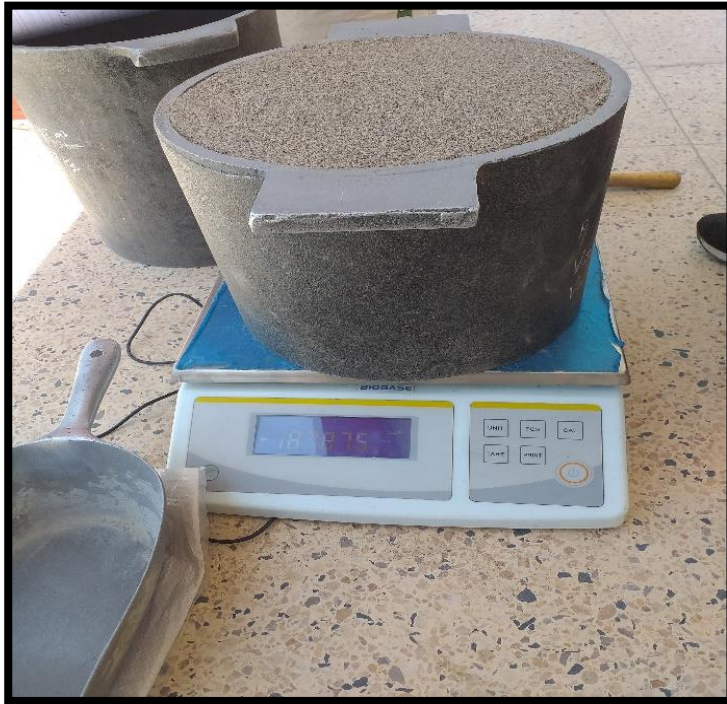
Anexo N°3 Peso Unitario Suelto y Peso Unitario Compactado de Agregado Fino.
