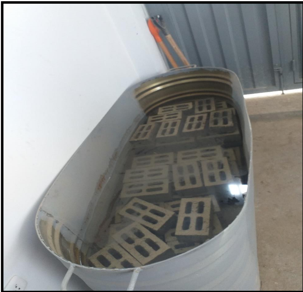
Anexo N°12 Poza de Curado de los Ladrillos de Concreto PET.
