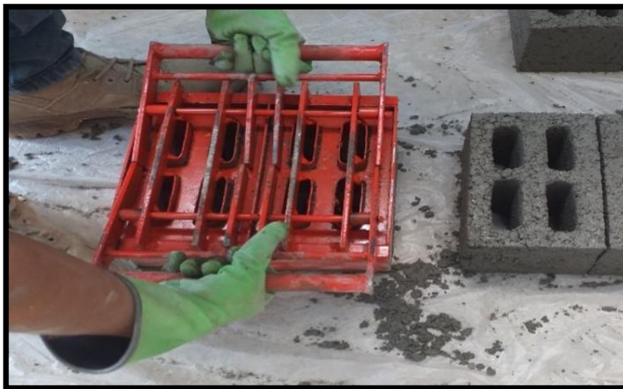
Fig. 9 Desmolde de Unidad de Albañilería
