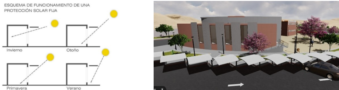
Figura 41 Elementos horizontales, celosías, parasoles
