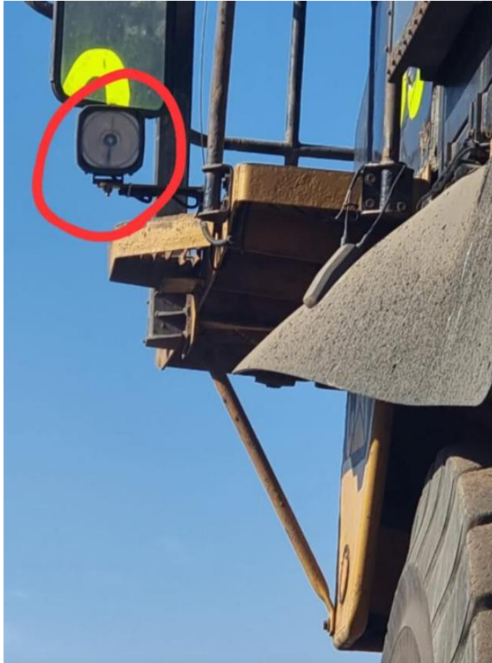
Fig. 19: Rotulado de bulbos y faros para control de ciclo de vida (PM 500horas)
