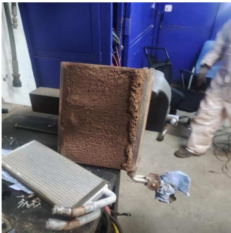
Fig. 18: Pruebas de limpieza y equipo de aire acondicionado (PM 250horas)
