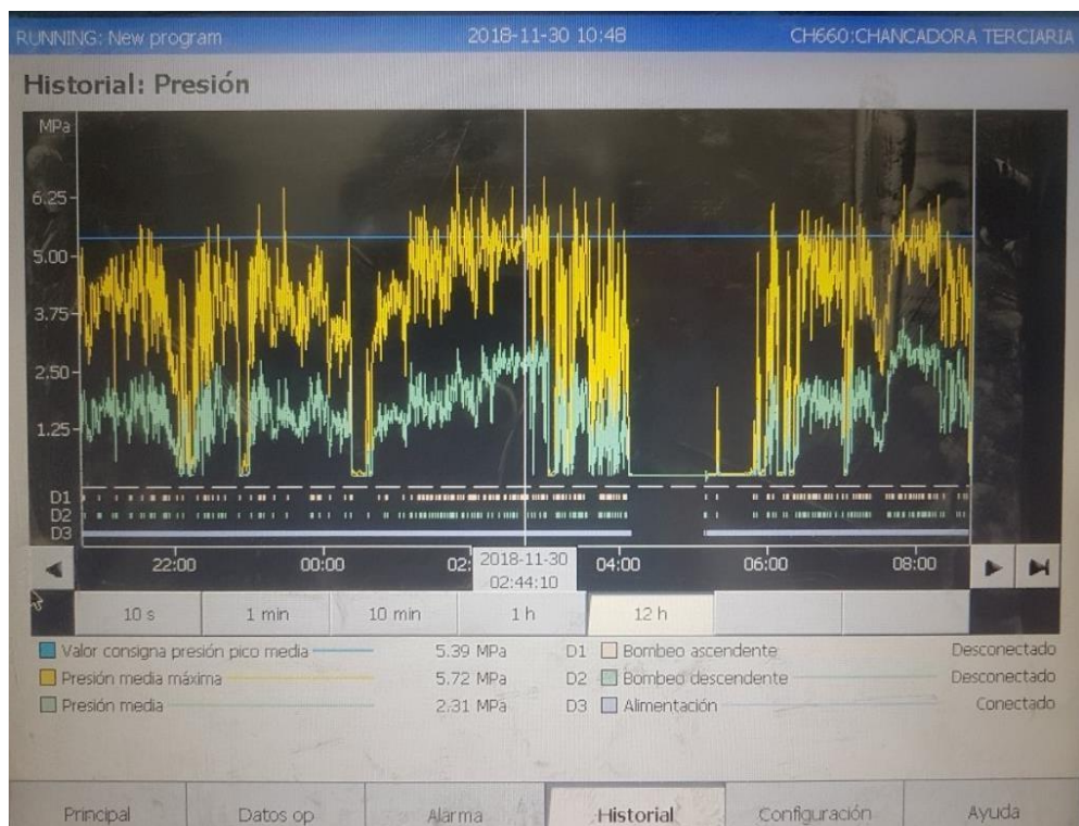
Fig. 12 Panel ASRI chancadora terciaria
