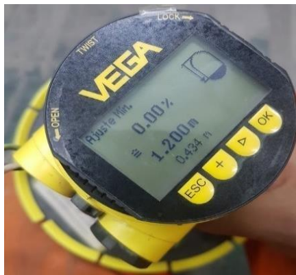
Fig. 14 Configuración de transmisor de nivel
