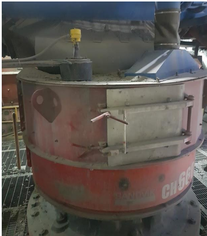
Fig. 18 Instalación física del transmisor de nivel sobre la chancadora
