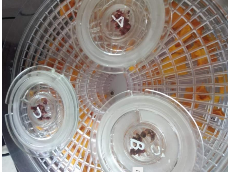
Figura 49 Muestras de tuna en placas konguay para ensayo a 30 °C y 40°C
