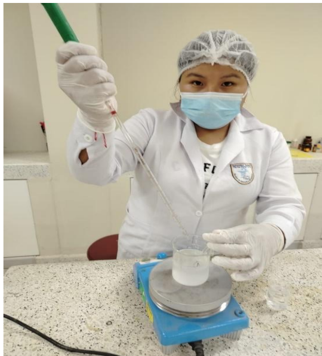
Precipitando los sulfatos
