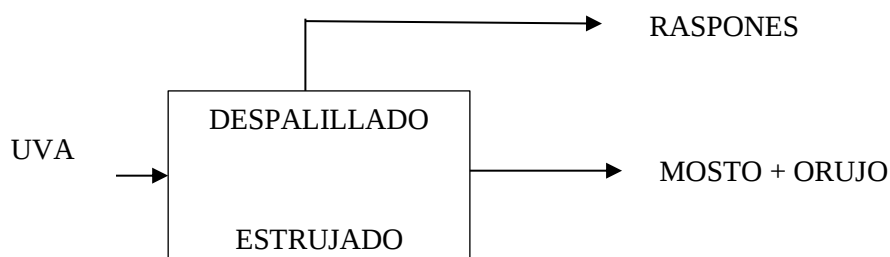
Fig. 8: Residuos en el despalillado y estrujado
