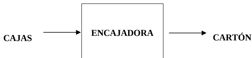
Fig. 14: Generación de residuos en el encajado
