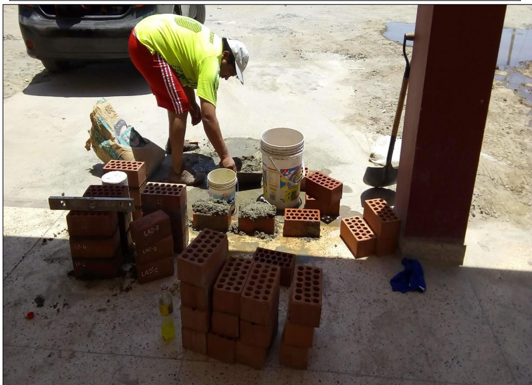
Preparando las unidades de albañilería para el ensayo de compresión en pilas con ayuda de un peón, Laboratorio de Mecánica de Suelos de la UNICA.
