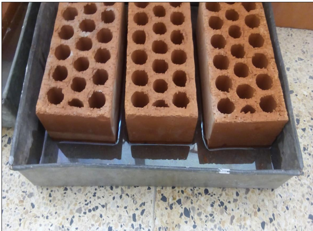
Ensayo de Eflorescencia a unidades de albañilería de 18 huecos, Laboratorio de Mecánica de Suelos de la UNICA.
