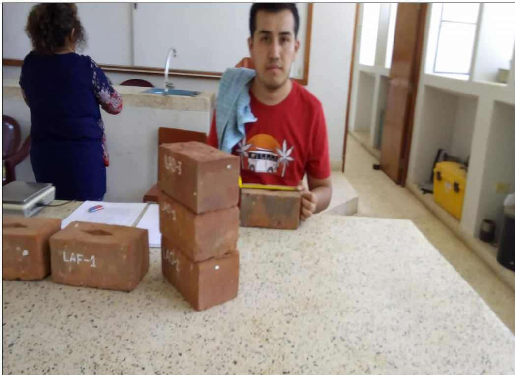
Ensayo de Variación Dimensional a unidades de albañilería de 18 huecos, Laboratorio de Mecánica de Suelos de la UNICA.
