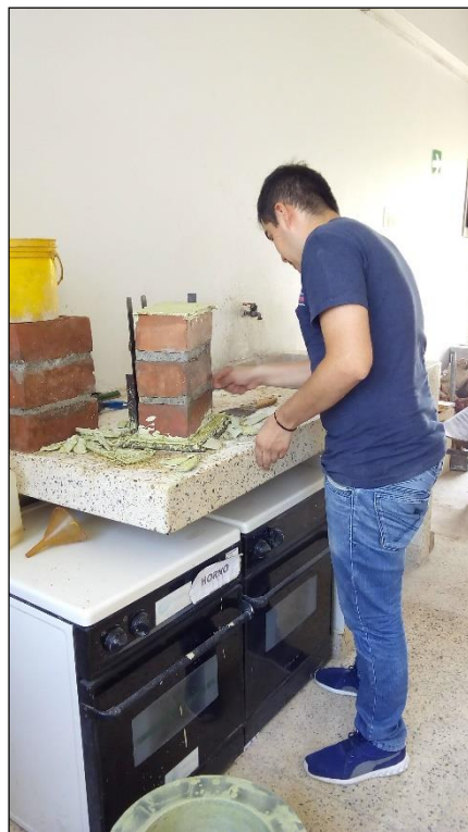
Preparación de las unidades de albañilería para ensayo de compresión en pilas, Laboratorio de Mecánica de Suelos de la UNICA.
