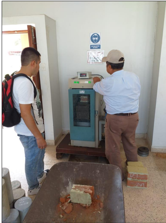
Realizando el ensayo de compresión individual a las unidades de albañilería, en presencia del Ing. Rene Canchari Vega.
