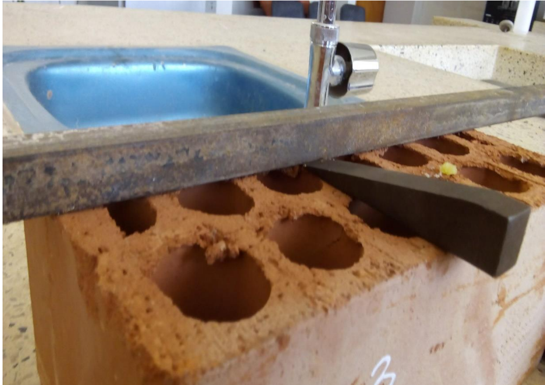
Ensayo de Alabeo a la unidad de albañilería, Laboratorio de Mecánica de Suelos de la UNICA.
