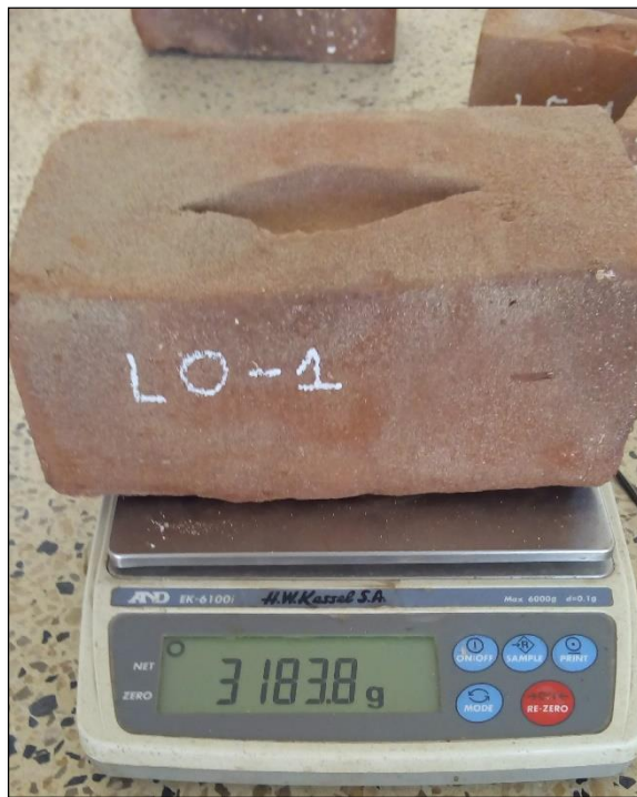
Peso de la unidad de albañilería, de la ladrillera Orongo, realizado en el Laboratorio de Mecánica de suelos de la UNICA.
