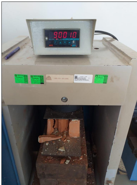
Unidad de Albañilería ensayada, en la máquina de compresión del Laboratorio de Mecánica de Suelos de la UNICA.
