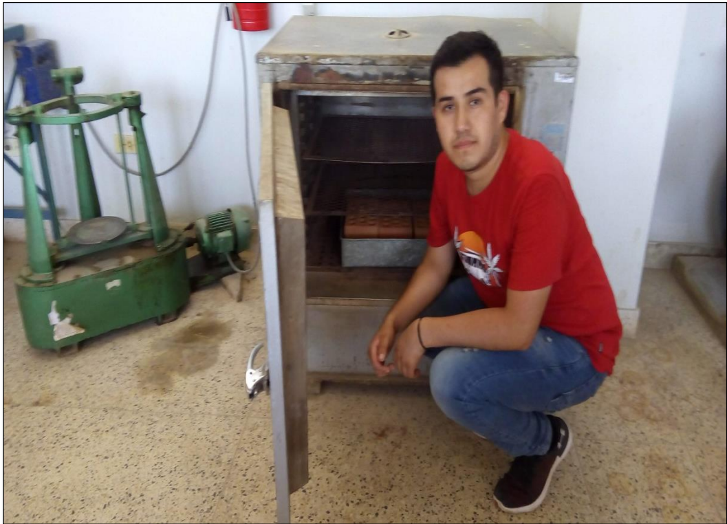
Retirando las unidades de albañilería del horno, Laboratorio de Mecánica de Suelos de la UNICA.
