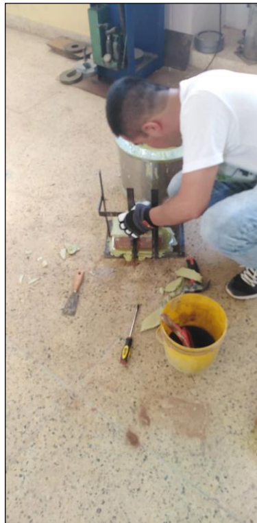
Realizando la preparación de la unidad de albañilería, para en el ensayo de compresión individual.
