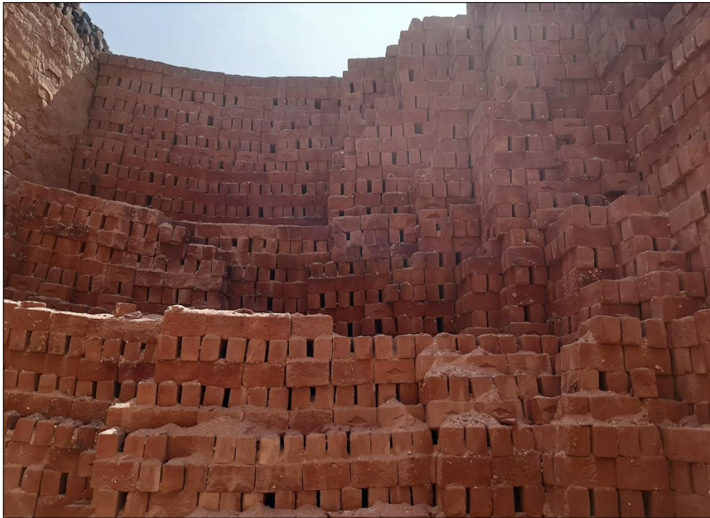
Producto ya terminado y enfriado del horno de cocción de la Ladrillera Orongo.
