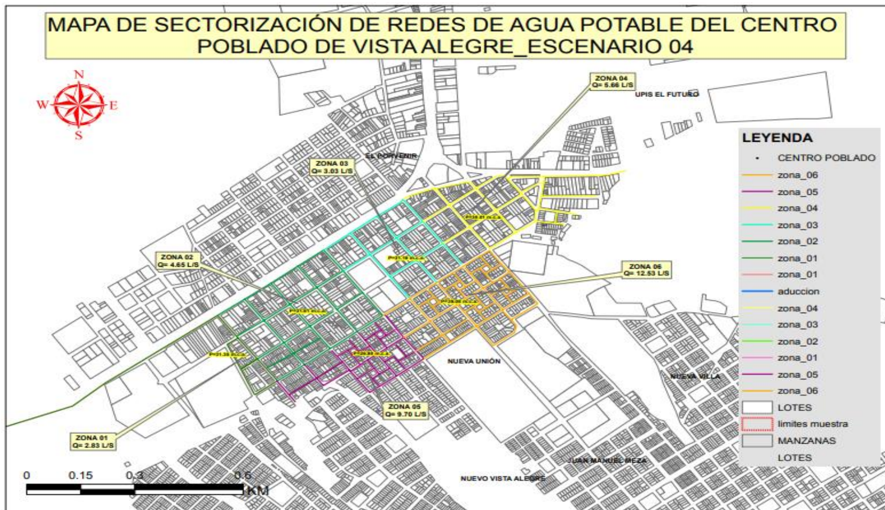
Fig. 46. Vista de las zonas de distribución obtenidas del modelamiento hidráulico y la sectorización de las redes de agua
