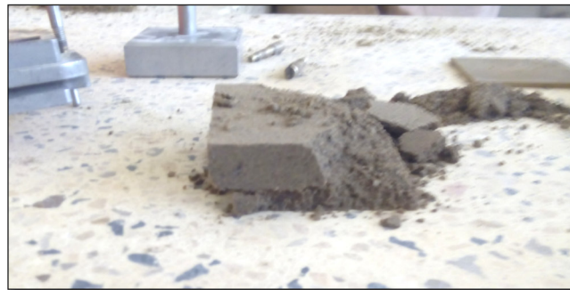
Especimen luego del ensayo de corte directo
