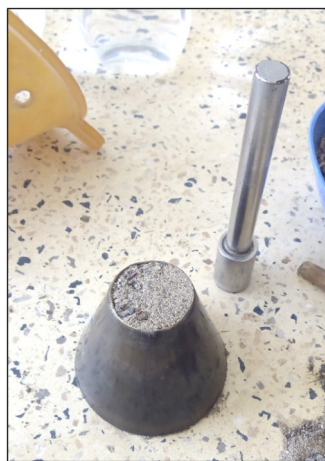
Muestra del poco pisón y picnómetro para ensayos de peso específico y absorción
