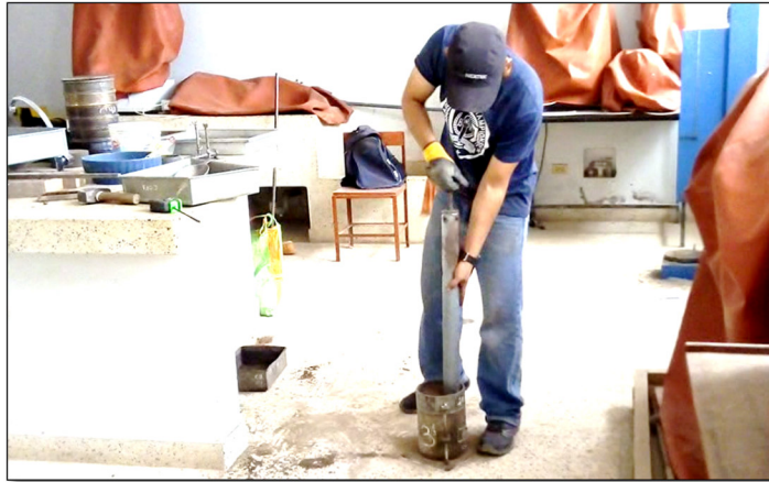
Proceso de compactación del suelo con el pistón (Ensayo Proctor Modificado)
