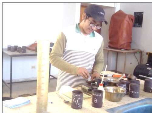
Ensayo de límite líquido de un suelo natural
