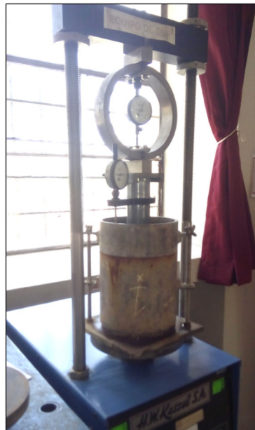
Realizando el ensayo de CBR
