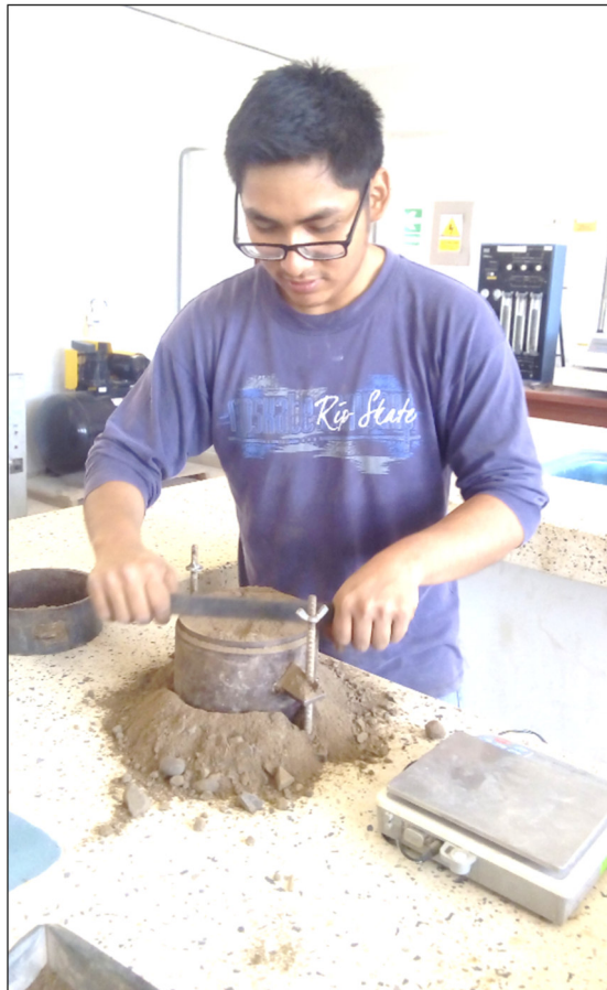
Ensayo de Proctor Modificado. Realizando el enrasado de muestra de suelo natural
