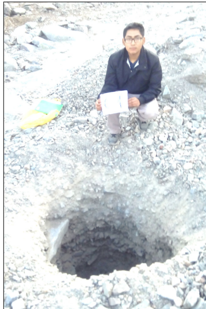
Exploración de cantera de agregados (C-1)
