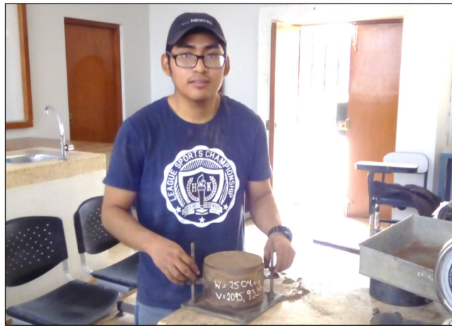
Pesaje de la muestra de suelo con el molde después del compactado con el pistón y enrasado
