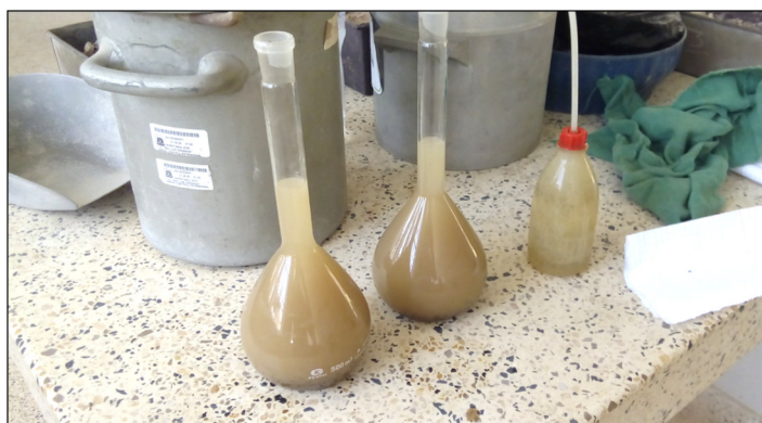
Vertido de agua, para llegar al nivel de la marca
