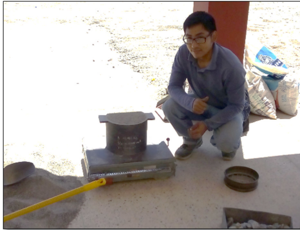
Desarrollando el ensayo de Peso unitario suelto y compactado
