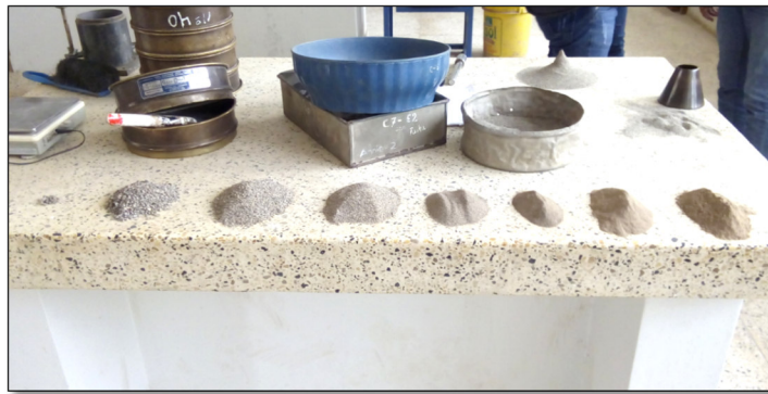
Vista de la clasificación de material que pasa la malla N°4, vemos lo retenido en las mallas (N°4, N°10, N°20, N°40, N°60, N°100, N°200, Fondo)
