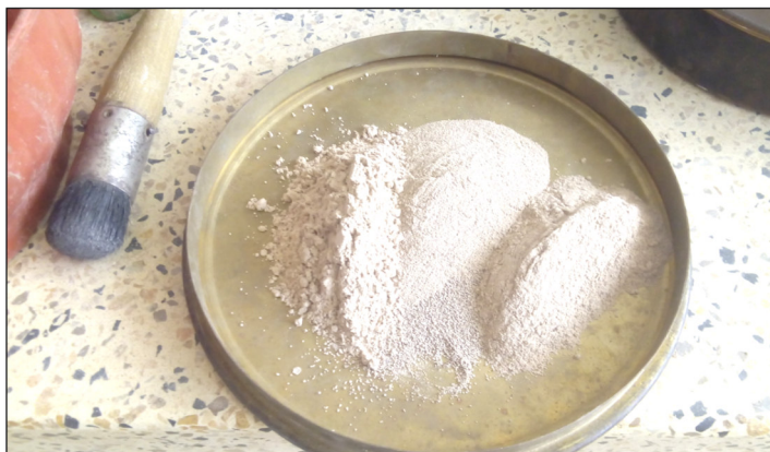
Selección de la muestra (Pasan # 40), para los respectivos ensayos de límite líquido y límite plástico
