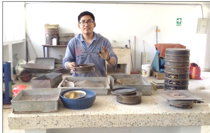
Realizando análisis granulométrico de muestras de suelo natural
