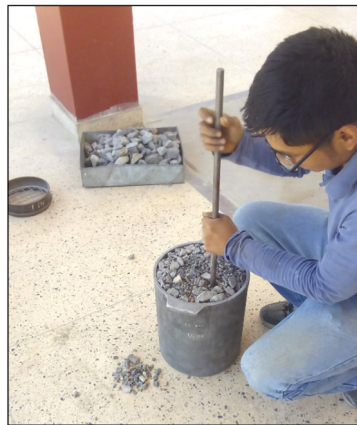
Realizando la compactación del agregado
