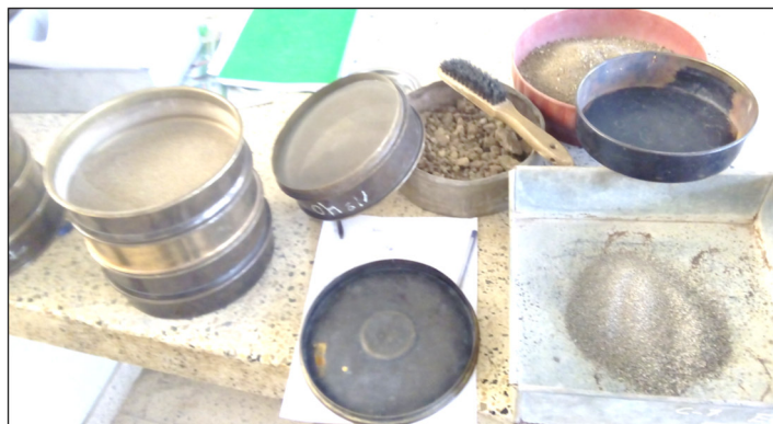
Proceso de extracción del material de las mallas para luego pesar lo retenido
