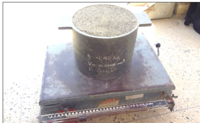
Balanza. Pesando el agregado fino, para encontrar su peso volumétrico suelto y compactado en el Lab. De la FIC Unica
