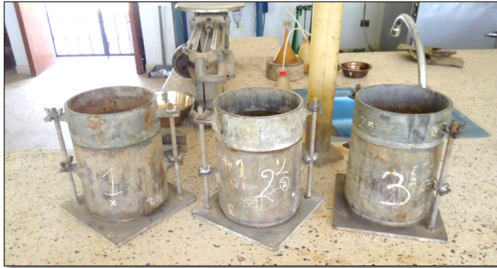
Preparación de los moldes para realizar el CBR
