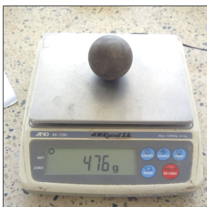
Bolas de acero del ensayo de abrasión Los Ángeles
