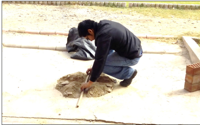
Realizando el respectivo cuarteo de muestra de suelo natural
