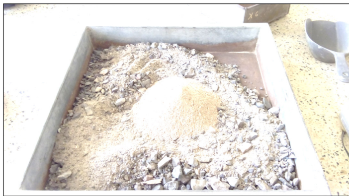
Análisis granulométrico de las muestra de material de afirmado
