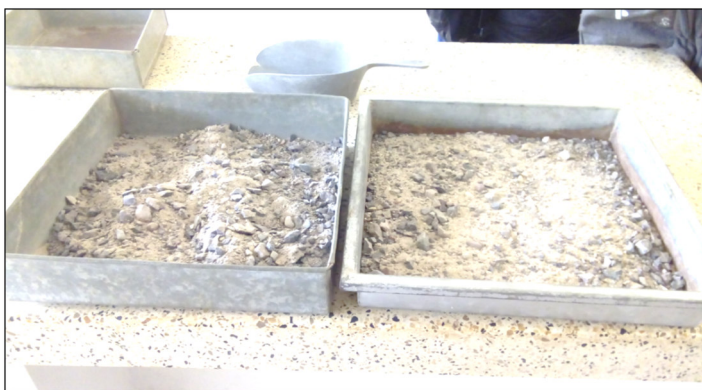
Preparación de la muestra para el ensayo de Proctor Modificado
