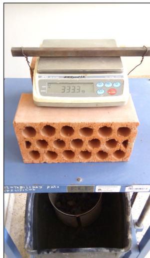
Aparato de flotabilidad para el ensayo de peso específico del Ag. Grueso
