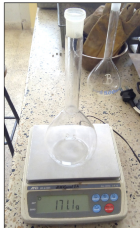
Muestra del poco pisón y picnómetro para ensayos de peso específico y absorción
