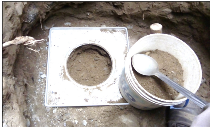
Extracción de material del orificio
