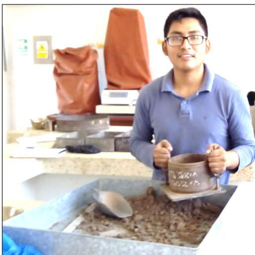
Realizando el ensayo Proctor Modificado
