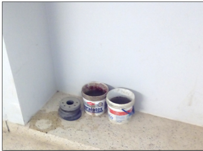
Saturado de las muestras de Ag. Grueso por 24 horas
