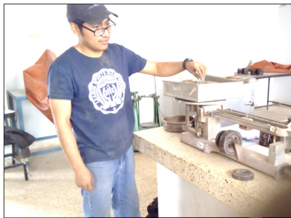
Realizando el pesaje de la muestra para el ensayo de Proctor Modificado en la balanza manual
