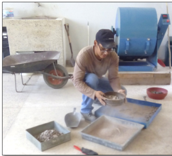
Luego del ensayo de abrasión para el pesaje el material que retiene la malla #10
