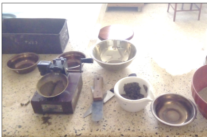
Realizando el ensayo de límite líquido
