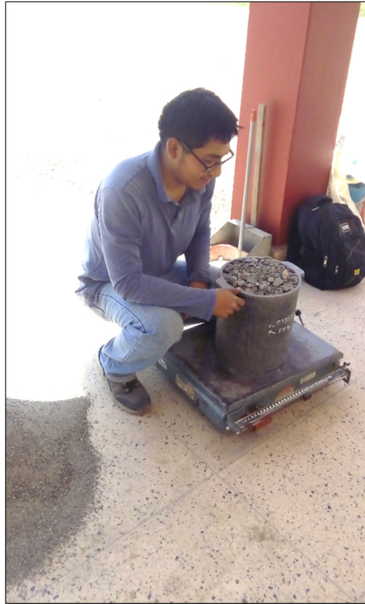
Ensayo de agregados (Pesos volumétricos). Pesando en la balanza el agregado grueso en la FIC
