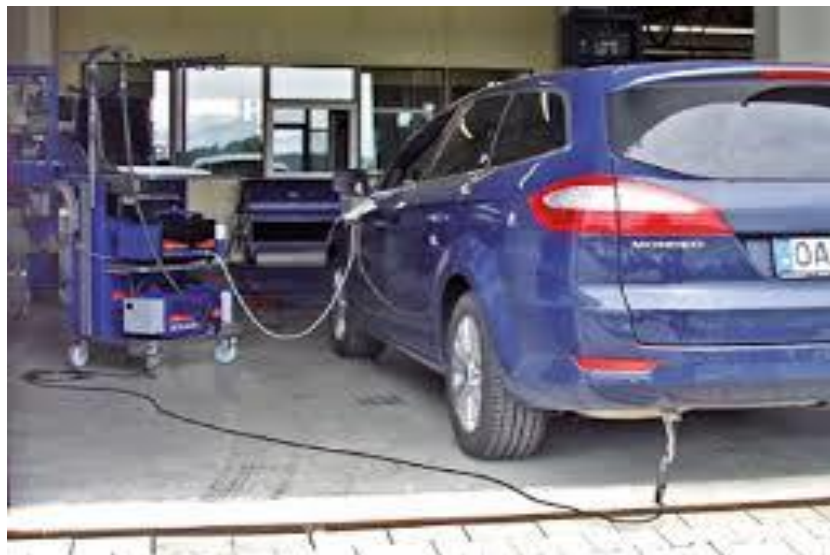
Fig N° 03: Equipo de medición para vehículos diesel analizador de partículas
