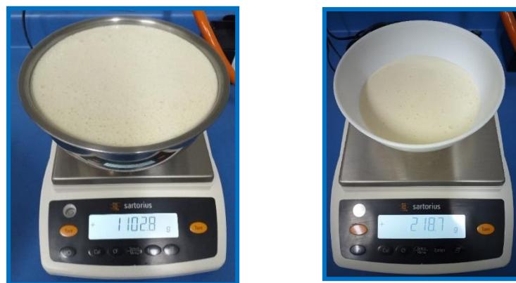
Figura 79 Pesado de la mezcla
