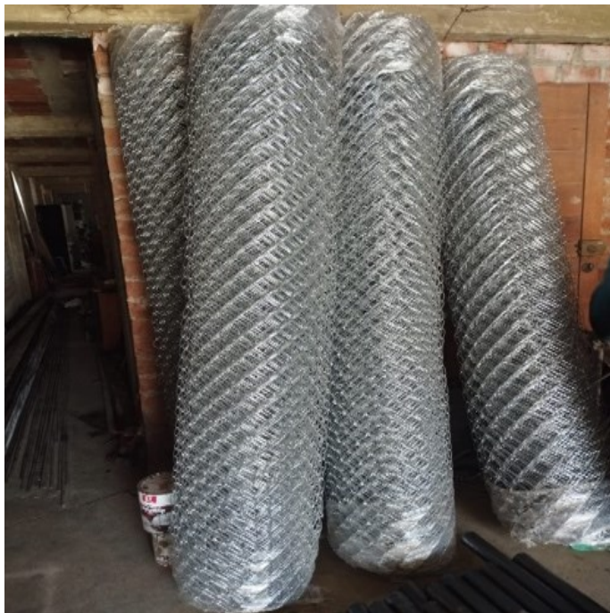
Fig. 48. Se verifica los materiales para la fabricación de cerco de malla metálica
