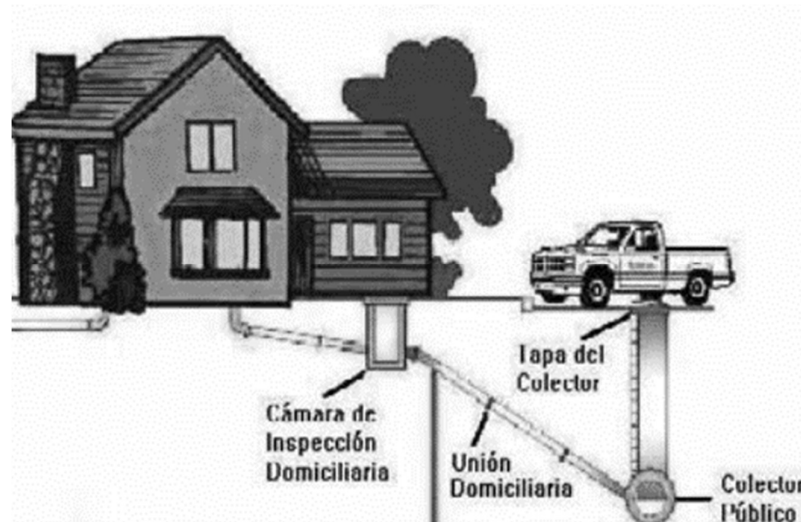
Fig. 1: Esquema de una conexión domiciliar
