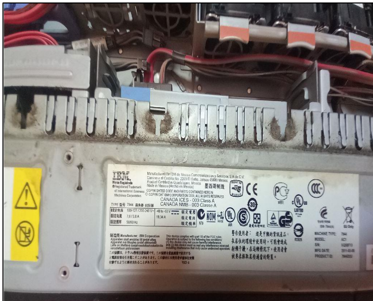
Fig. 4. Acumulación de polvo en los componentes del servidor IBM
