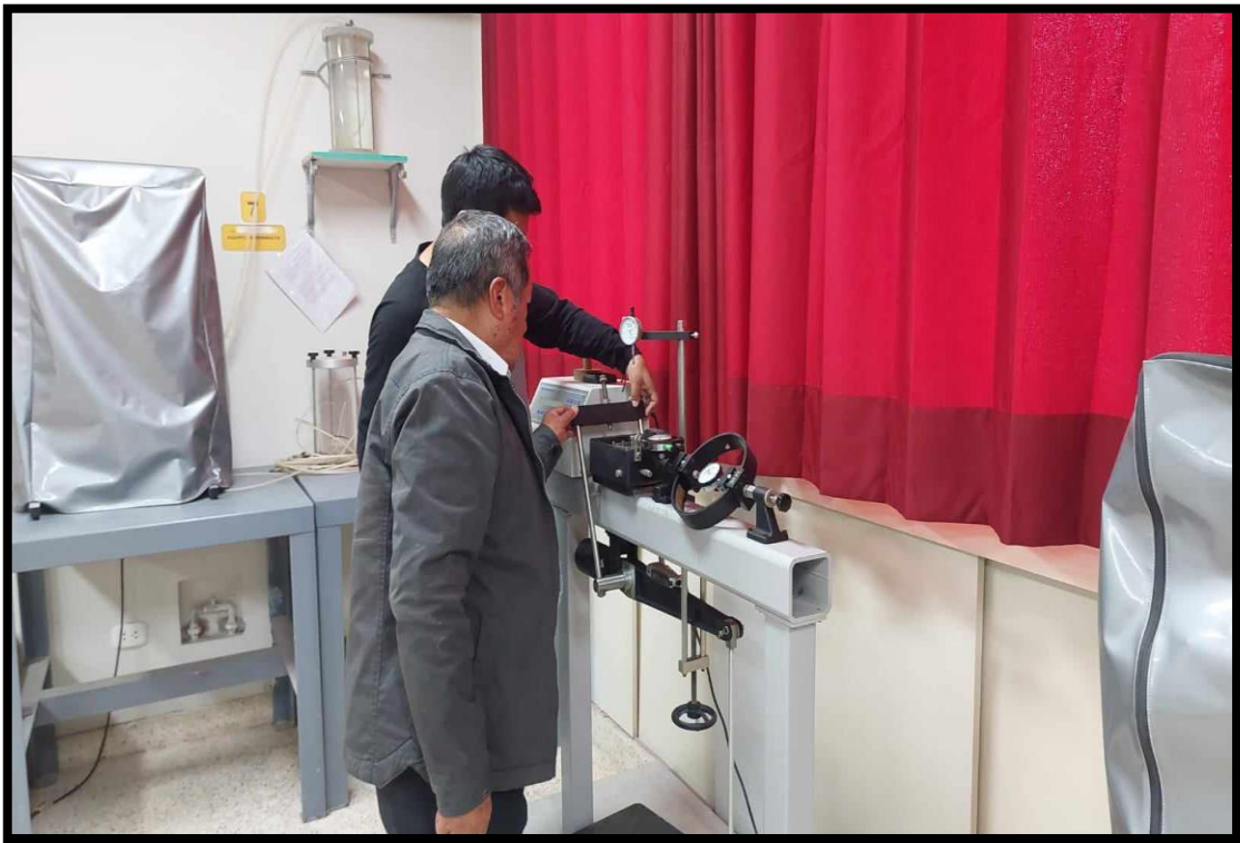
Figura 94. Realización de ensayo de corte directo en laboratorio FIC. Fuente: Creado por el autor.
