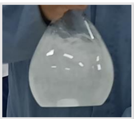
Figura 7.5 Coloración lechosa de la solución de NaOH al 30%
