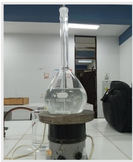
Figura 7.4 Agitación de la solución de soda caustica al 30%
