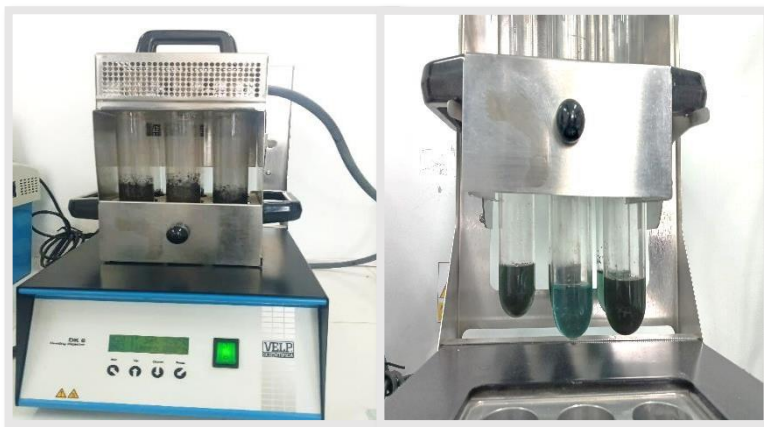
Figura 2.14 Proceso de digestión en el equipo Kjeldahl semiautomático
