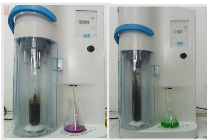
Figura 2.15 Proceso de destilación en el equipo Kjeldahl semiautomático
