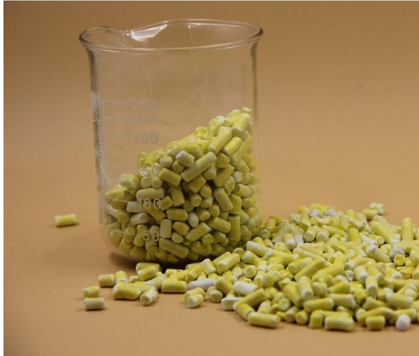
Fig. 13. Pellets de xantato isopropílico de sodio (Z-11) [7]
