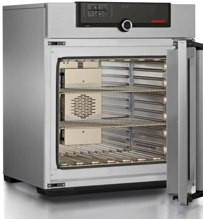
Fig. 14. Estufa de secado con termostato regulable [5]
