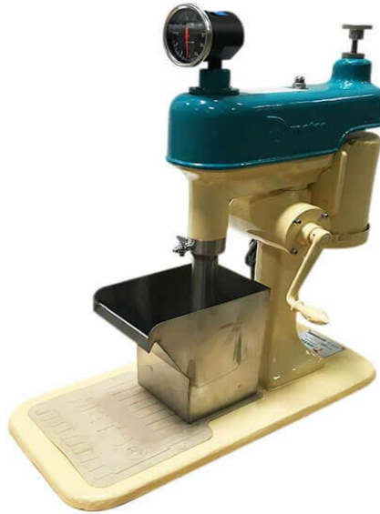
Fig. 18. Celda de flotación Denver [5]
