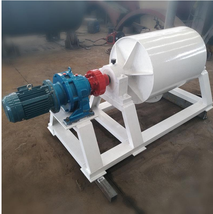
Fig. 17. Molino de bolas de laboratorio [5]
