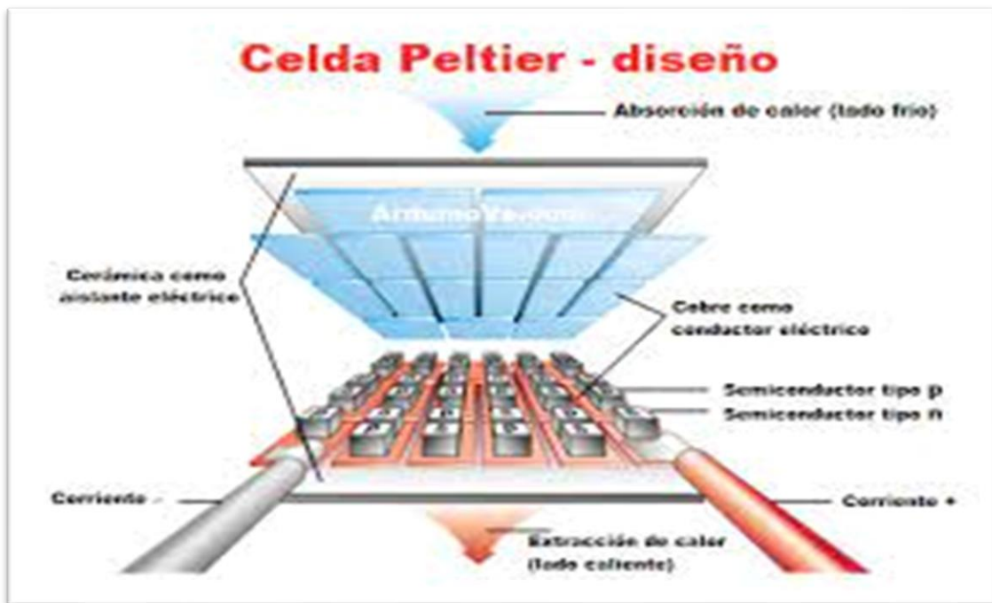
Figura 15. Celda Peltier diseño interno
