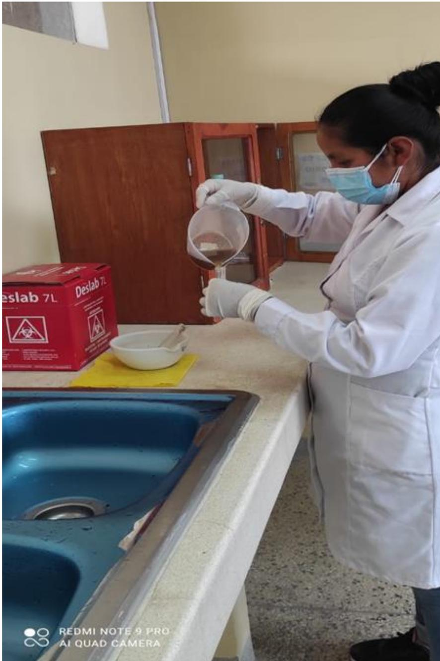
**Imagen 19, 20 y 21. Mezcla de solución saturada con la muestra en el mortero.**
