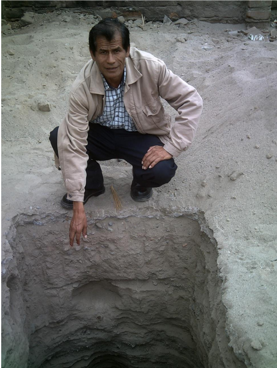
Fig. 70. Vista perforado y exploración de toma de muestras estratos de suelos
