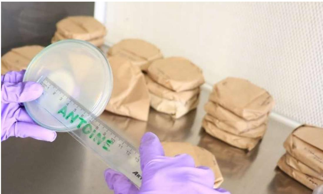
**Figura 16.** Procedimiento de monitoreo, medición de radio de la colonia.
