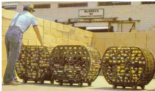
Figura 5. Enfriamiento de la carga
