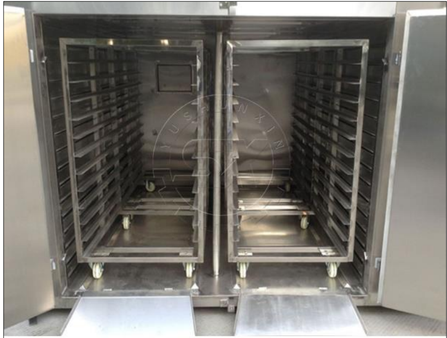
Fig N° 08: Horno de secado con circulación de aire caliente
