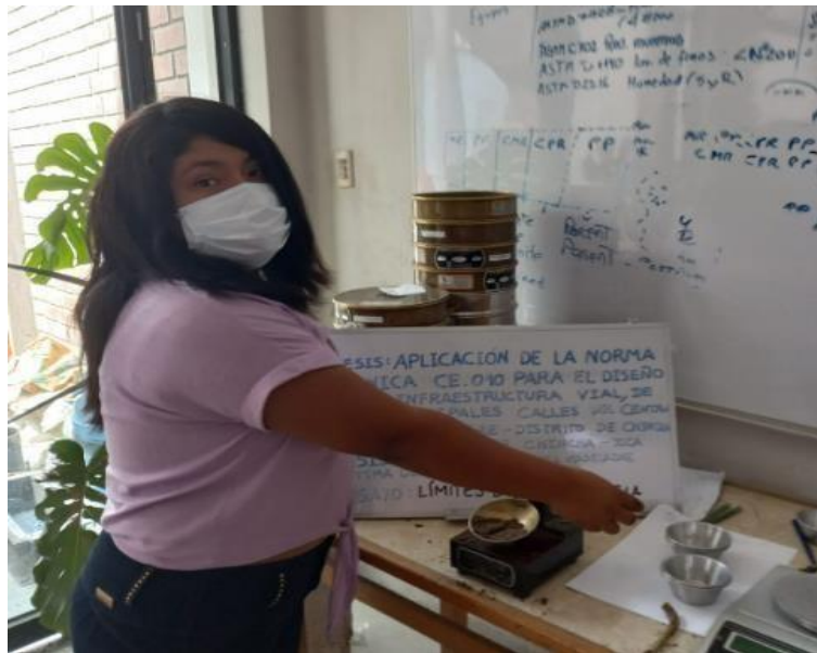
Fig. 17. Colocación de una porción de muestra en la copa del aparato de Casagrande
