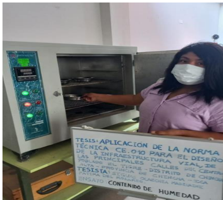
Fig. 18. Colocando la muestra en el horno para calcular el contenido de humedad
