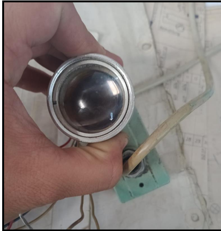
Fig. 11: Sensor fotoeléctrico original de la máquina
