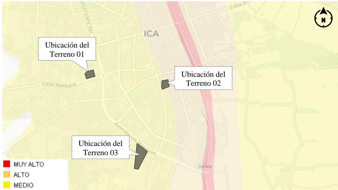
Figura N° 09: Análisis de peligro por Inundación Fluvial de los terrenos propuestos.
