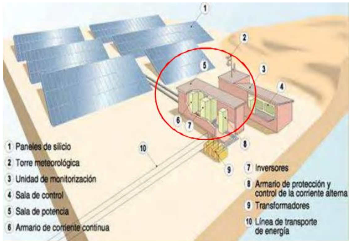
Fig. 10 Estación de monitoreo y control
